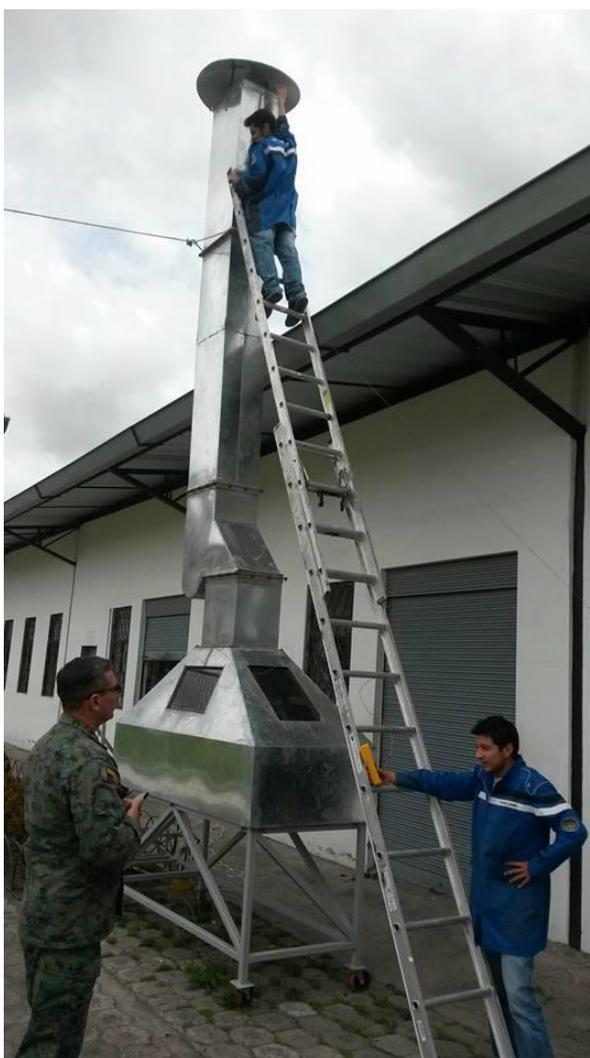
**Figura 87. Medición de la temperatura al final de la chimenea.**
