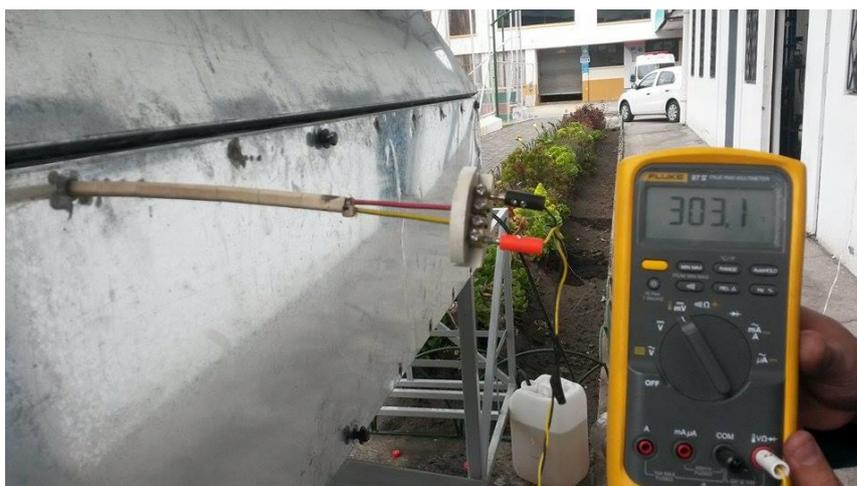
**Figura 86. Medición de la temperatura en el hogar.**
