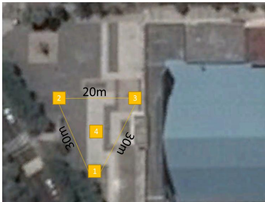
Figura 48. Distribución de los Nodos en el Terreno de Cemento. 1) Nodo Router Base 2) Nodo Coordinador 3) Nodo Router Desconexión 4) Nodo DRON
