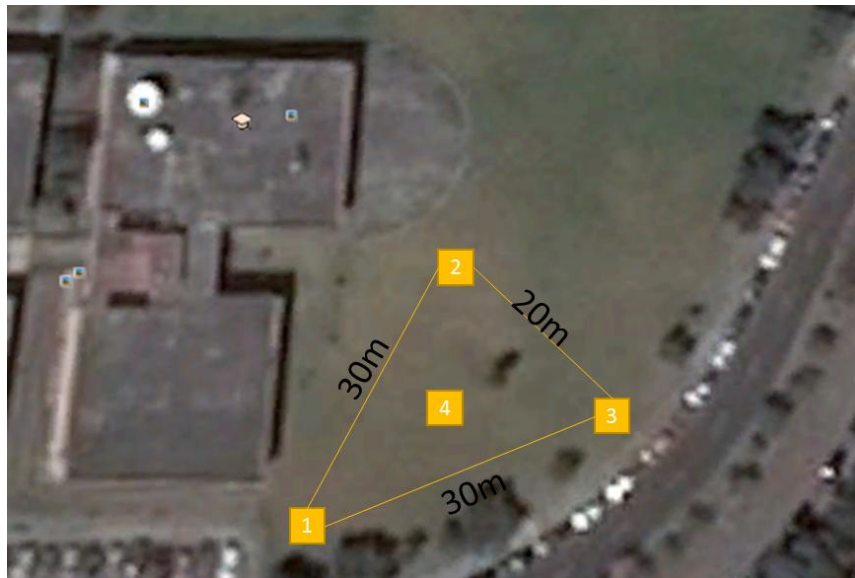
Figura 44. Distribución de los Nodos en el Terreno de Césped. 1) Nodo Router Base 2) Nodo Coordinador 3) Nodo Router Desconexión 4) Nodo DRON
