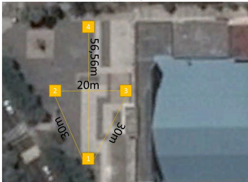
Figura 51. Distribución de los Nodos en el Terreno de Cemento. 1) Nodo Router Base 2) Nodo Coordinador 3) Nodo Router Desconexión 4) Nodo DRON
