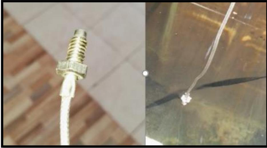
**Figura 31:** Toma de diferencial de Temperatura – Termocupla
