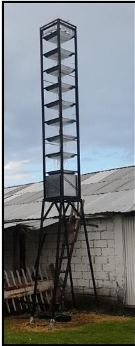
**Figura 91:** Verificación de Torre de Enfriamiento con Flujo Activo
