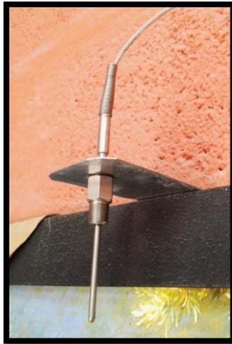
**Figura 89:** PT100 medidor de temperatura ambiente
