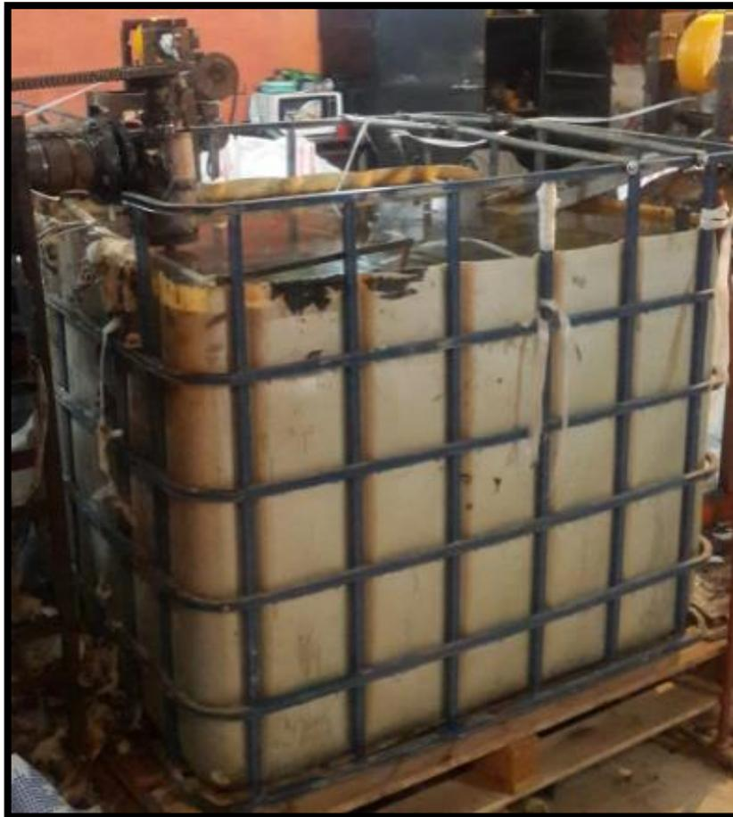
**Figura 8:** Tanque de Agua de Enfriamiento de Malla de polietileno.
