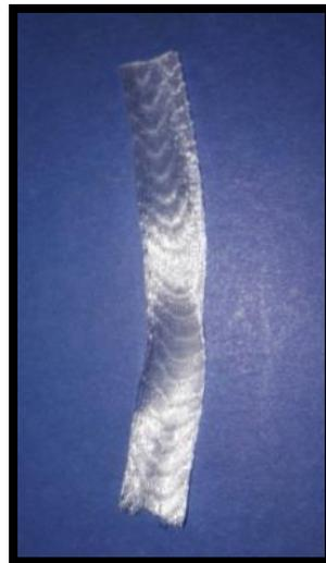
**Figura 99:** Malla de Polietileno sin falla en el ajuste (memoria)
