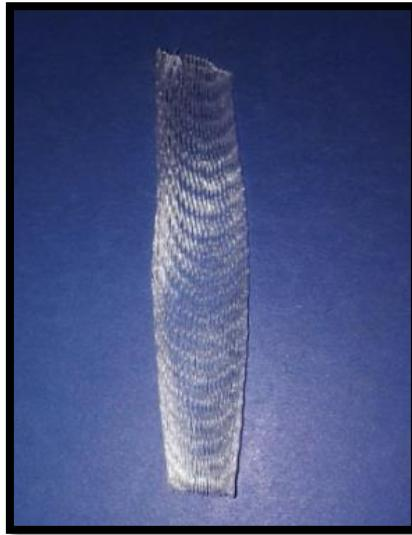
**Figura 98:** Malla de Polietileno con falla en el ajuste (memoria)
