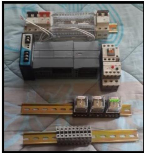
**Figura 89:** Ubicación de Elementos tablero de control
