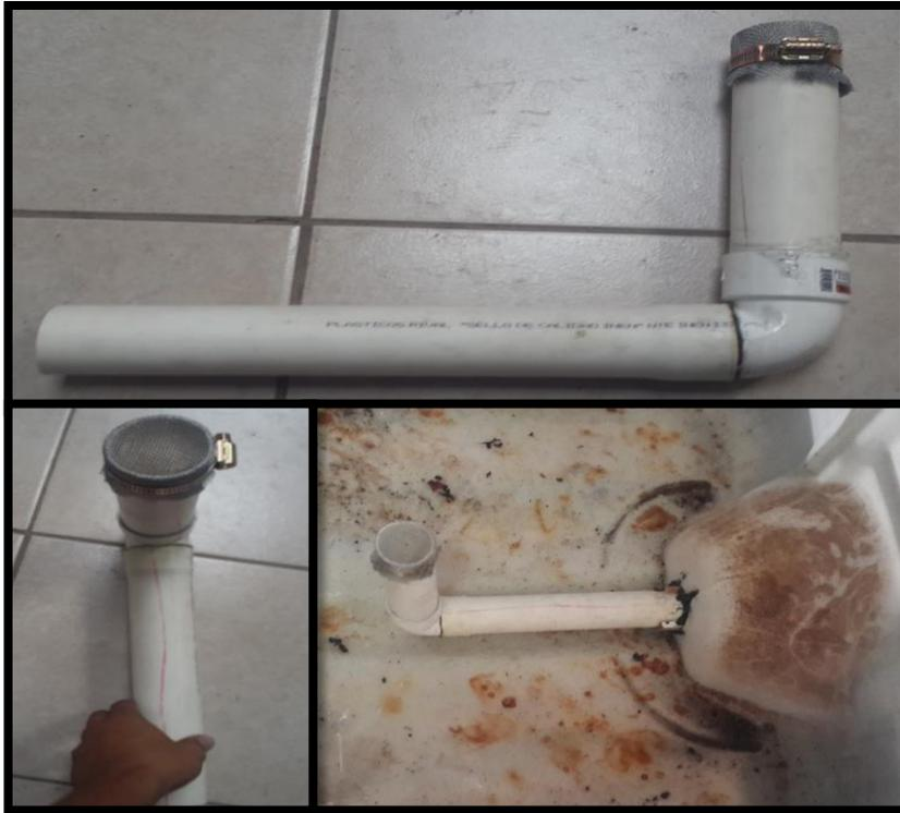
**Figura 72:** Filtro para sedimentos PP
