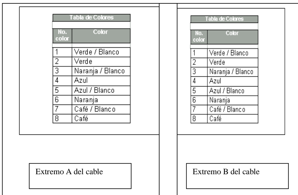
Figura 3.4 Distribución de colores en cada extremo del cable
