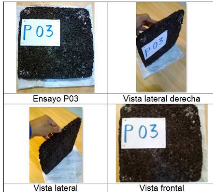
Figura 24. Mezcla de materiales y aglomerados panel P3
