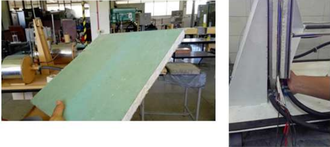
Figura 36. Instalación del material de prueba en el equipo
