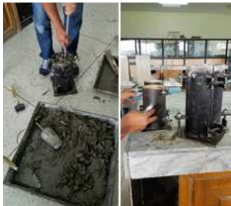
Figura 45. Compactación de probetas
