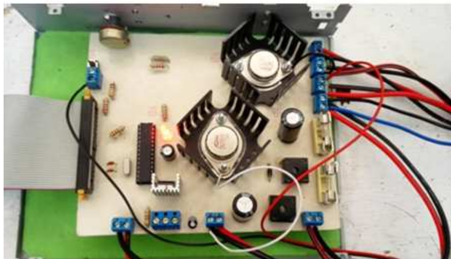
Figura 28. Tarjeta de control de sistema de placa caliente
