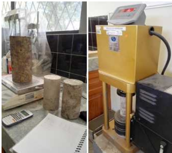
Figura 47. Ensayo de compresión
