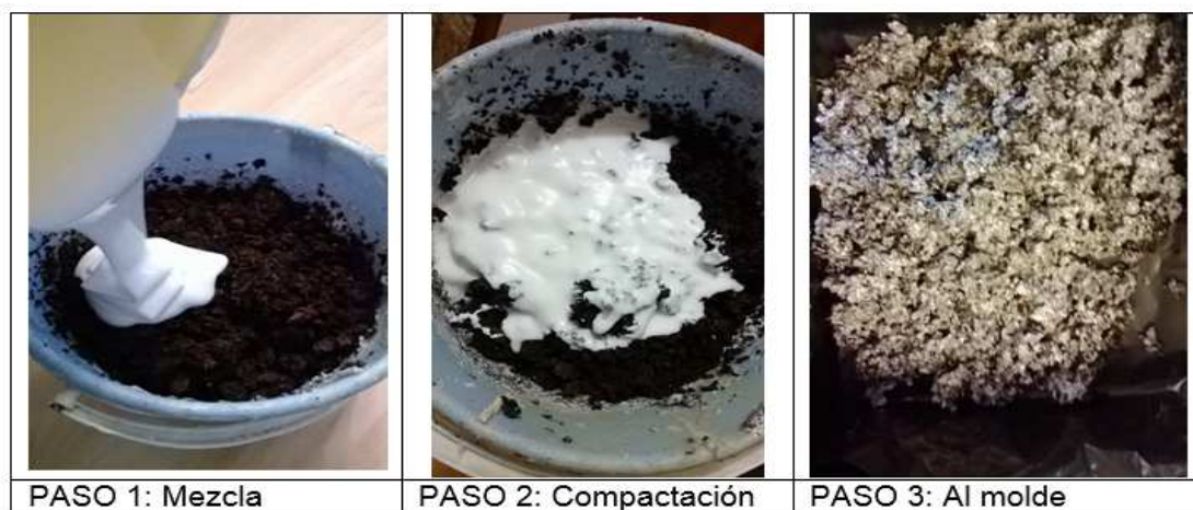
Figura 23. Mezcla de materiales y aglomerados panel P3
