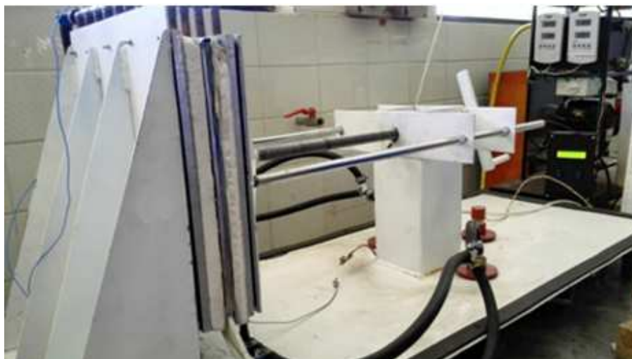
Figura 29. Máquina de medición de coeficiente térmico
