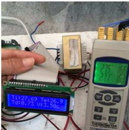
Figura 37. Estabilización de temperaturas entre placa fría y placas calientes
