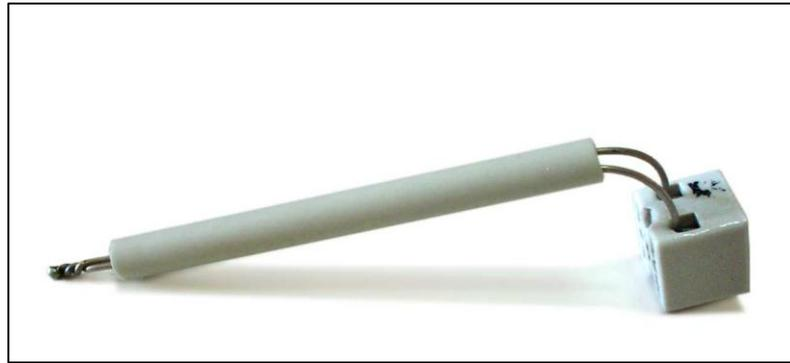
**Figura 8 Sonda termopar tipo K y bloque isotérmico**
