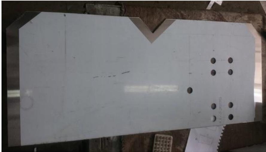
**a. Corte y perforación de la plancha de acero**
