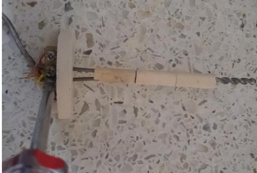
**a. Instalación de la termocupla en la bornera de cerámica**
