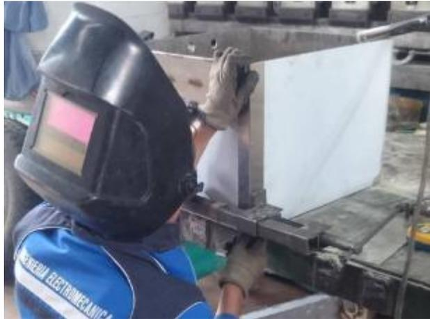
**a. Sujeción a presión del recubrimiento del horno**
