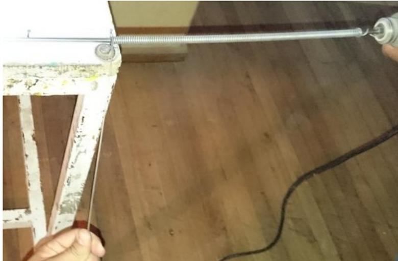
**Figura 36 Enrollamiento de las resistencias eléctricas**
