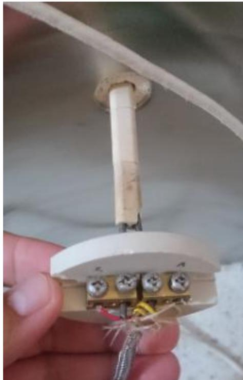
**b. Colocación de la termocupla en el interior del horno**
