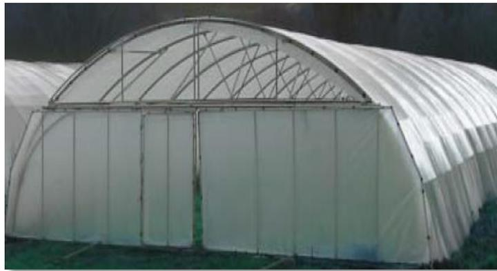
**Figura 11: Invernadero tipo túnel**
