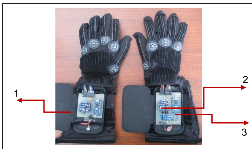
Figura 37: Montaje de dispositivos inalámbricos. 1) Xbee serie 1 guante izquierdo, 2) Xbee serie 1 guante derecho, 3) Bluetooth guante derecho.
