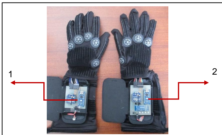
Figura 36: Montaje de las tarjetas controladoras. 1) Tarjeta controladora del guante izquierdo y 2) tarjeta controladora del guante derecho.
