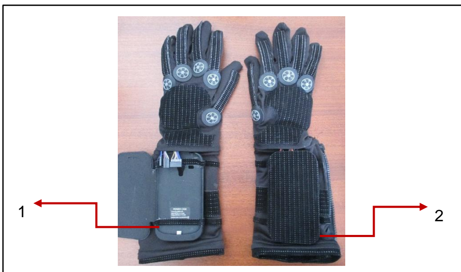
Figura 35: Montaje de las baterías. 1) Batería en el guante izquierdo y 2) batería en el guante derecho.
