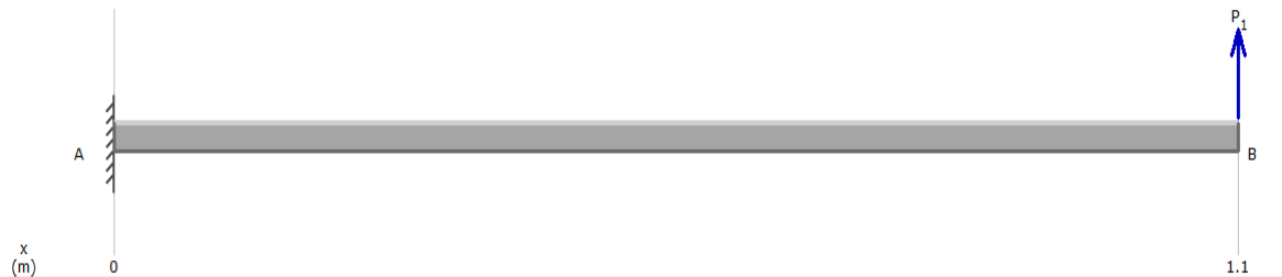
Figura 41: Viga en voladizo de la estructura
