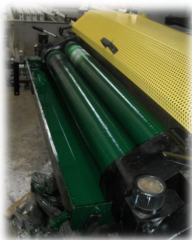
Figura 92: Prueba del sistema hidráulico agitando tinta
