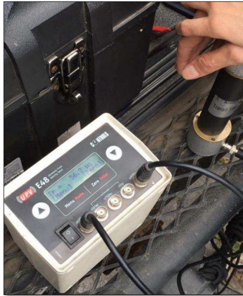
Figura 20. Calibración del equipo de ultrasonido
