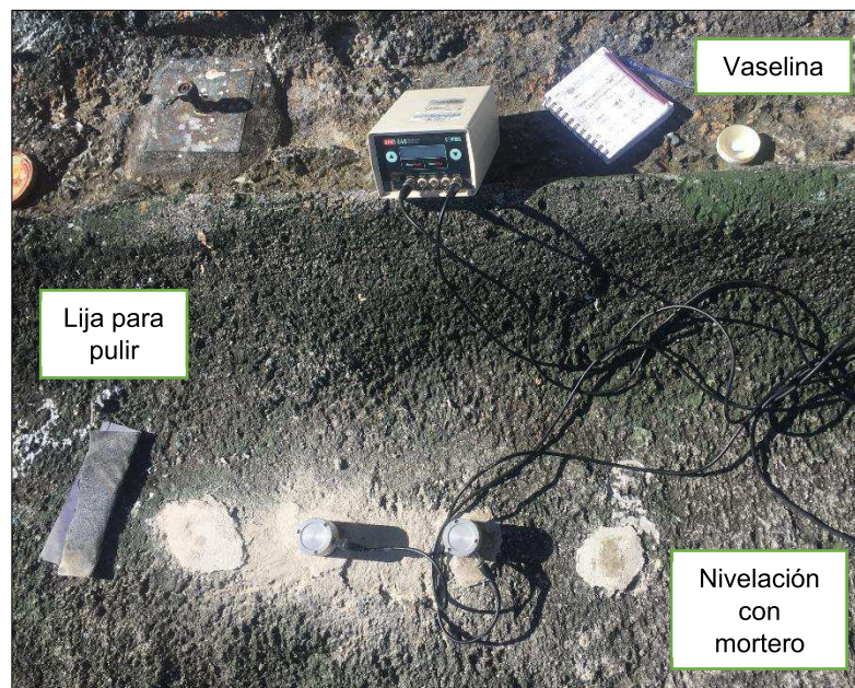
Figura 22. Procedimiento para acoplar los transductores
