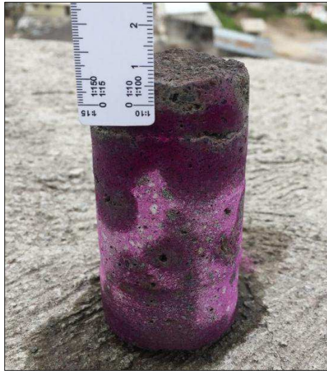
Figura 57. Ensayo de carbonatación Talud N°3
