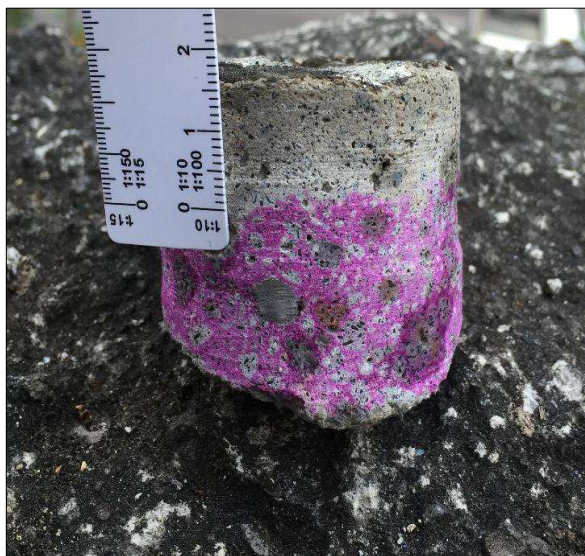
Figura 55. Ensayo de carbonatación Talud N°1
