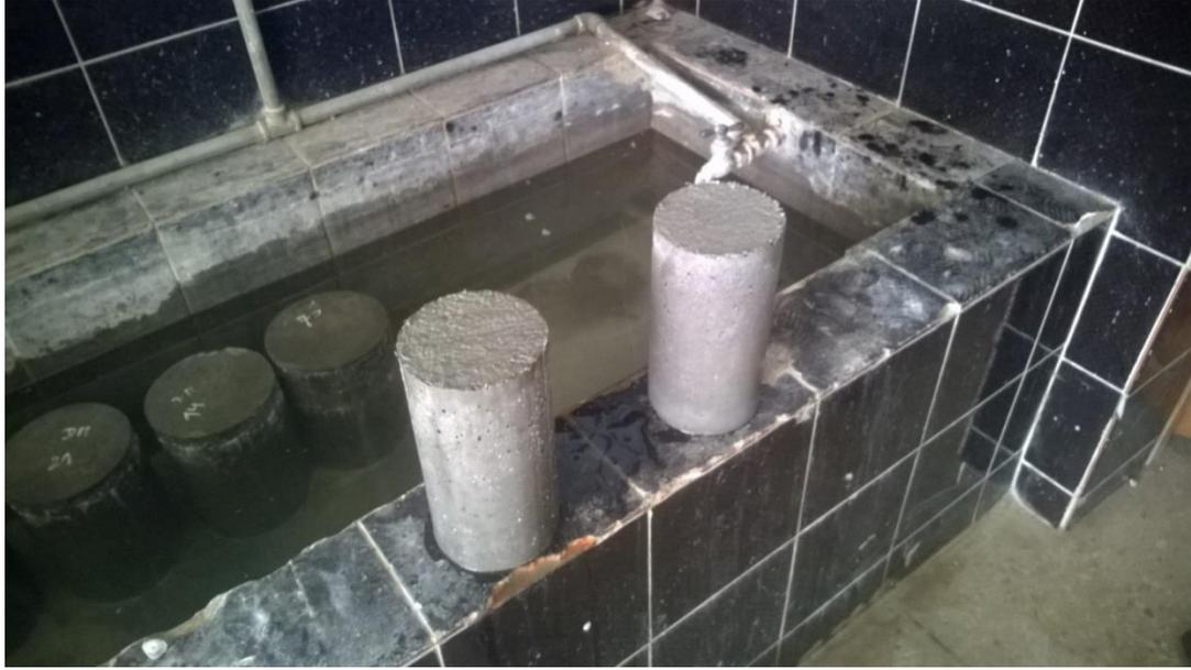
**Figura 4.10** Probetas solidas de la mezcla.
