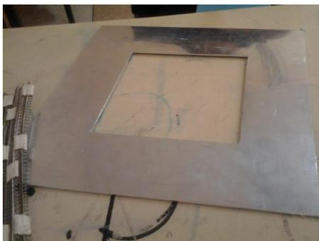
**Figura 4.14** Placa de aluminio del anillo de guarda.
