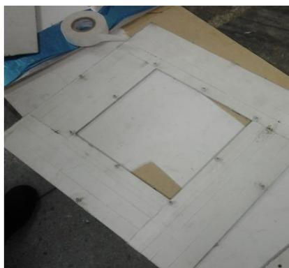
**Figura 4.15** Placa del anillo de guarda aislada.
