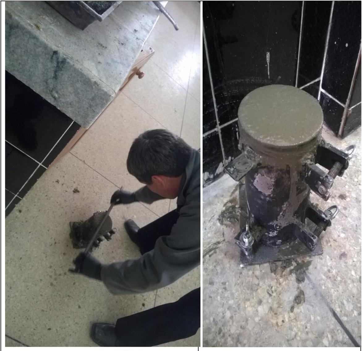
**Figura 4.9** Enrazado del exceso de concreto en el molde.
