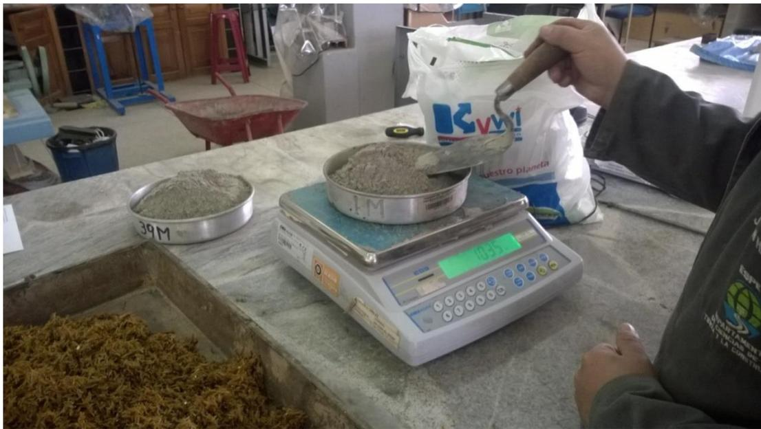
**Figura 4.2** Medición del peso de cemento en balanza electrónica.
