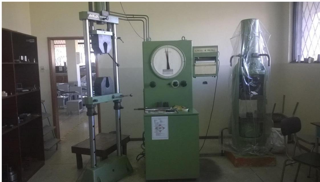
**Figura 2.3** Máquina de ensayos universales modelo FM – 1033 de la ESPE
