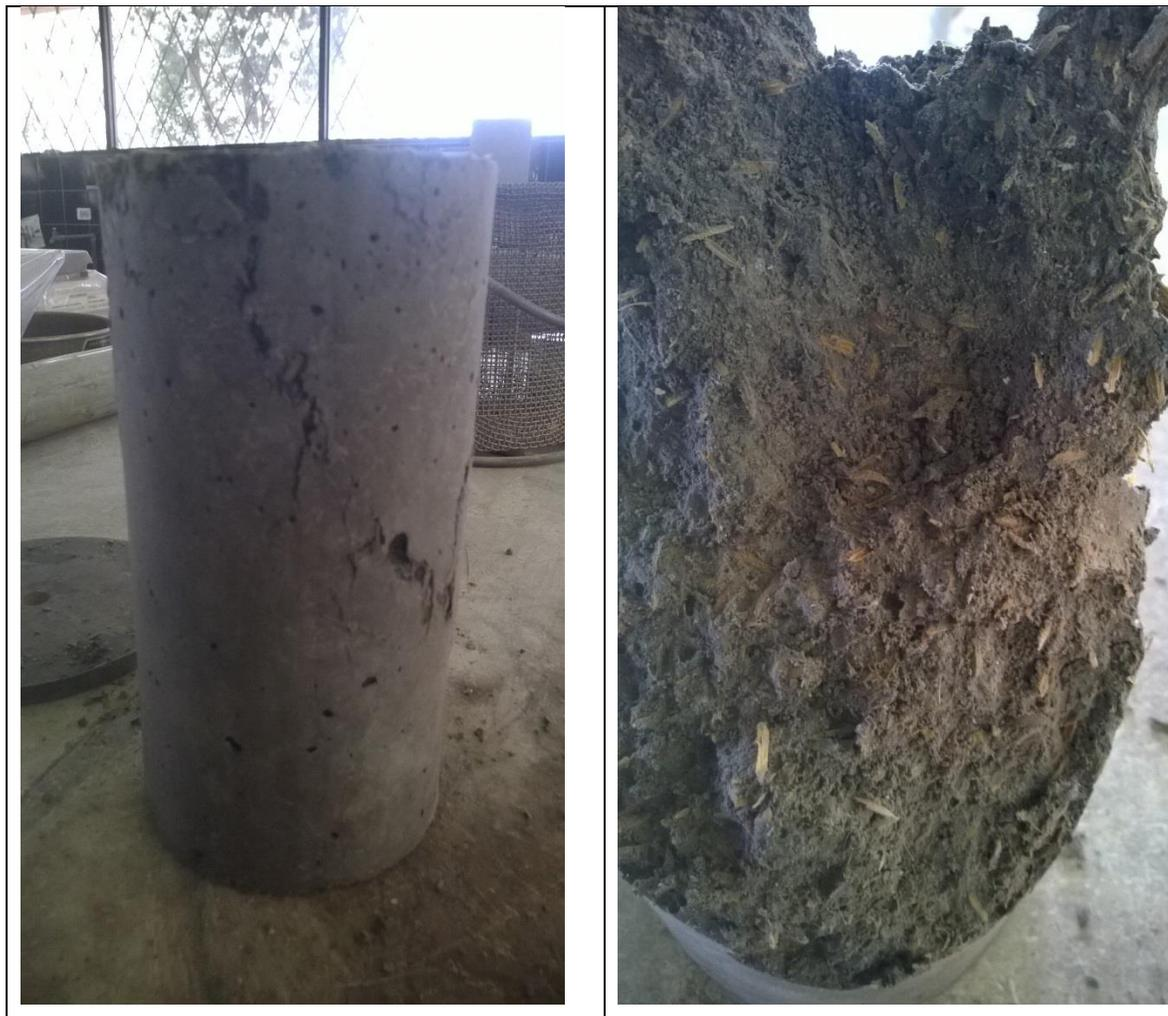
**Figura 4.12** Probeta sometida a la prueba de compresión.
