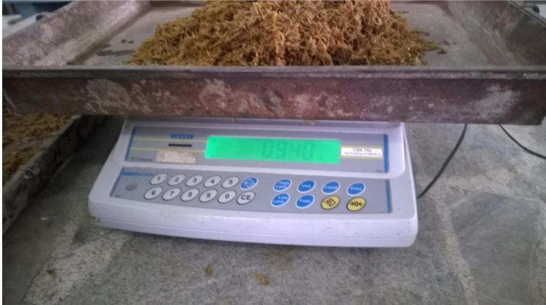
**Figura 4.1** Medición del peso de cascarilla saturada en balanza electrónica.
