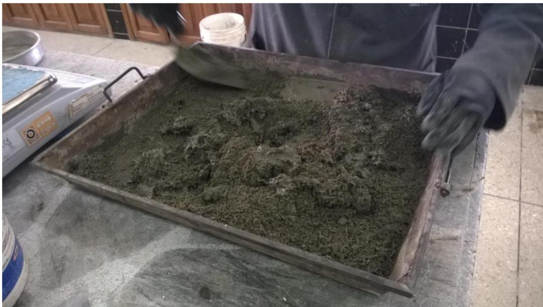
**Figura 4.5** Mezcla homogénea de cemento, cascarilla y agua.
