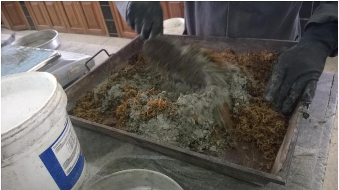
**Figura 4.4** Mezcla homogénea de cemento y cascarilla.
