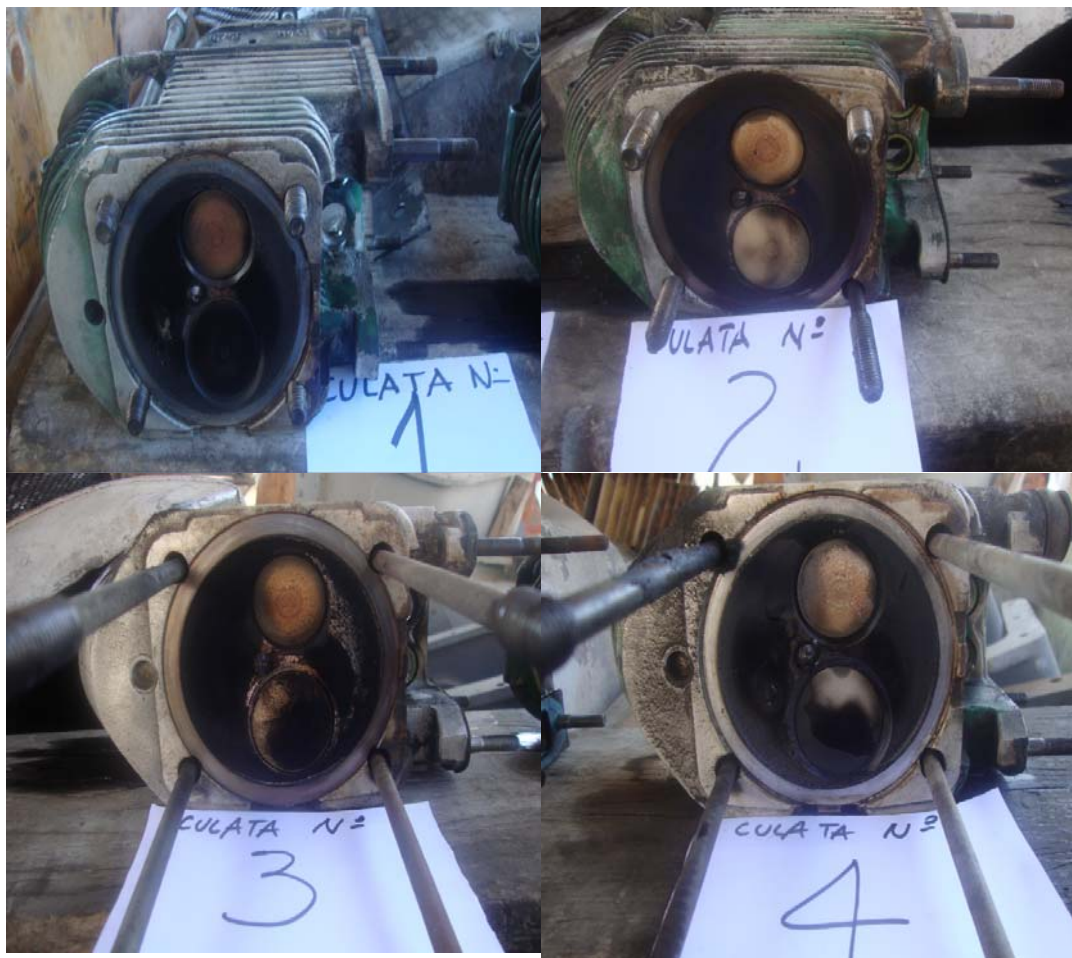
Figura 29. Fotografías de las culatas del motor Deutz F4L912 al terminar todas las pruebas con biodiesel
