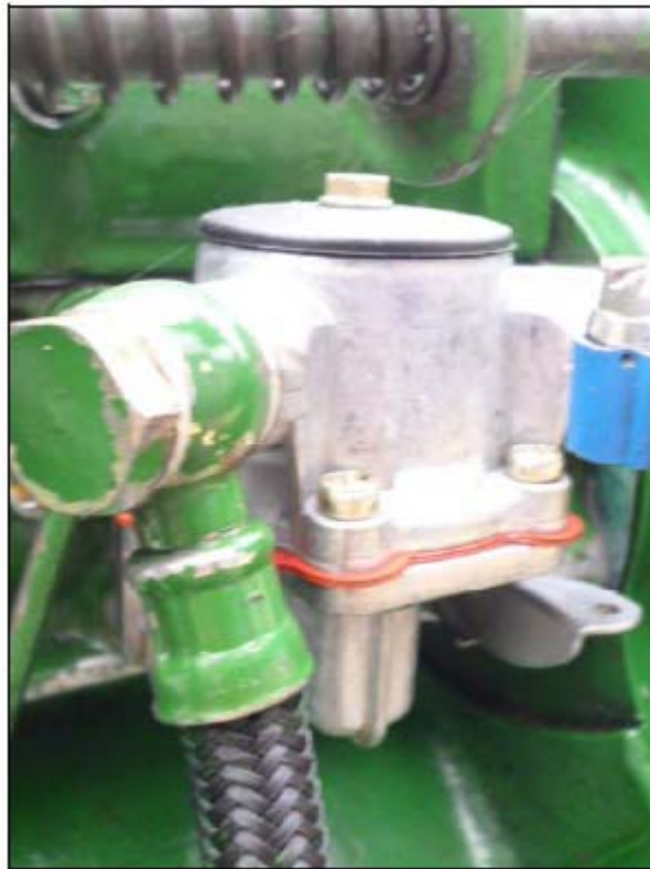
Figura 12. Bomba auxiliar de combustible
