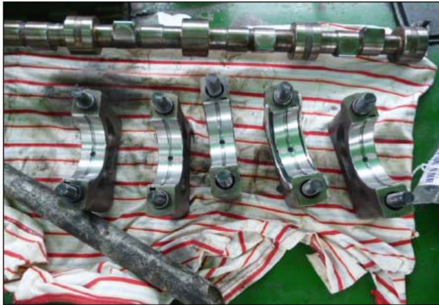
Figura 9. Cojinetes nuevos listos para colocar en el motor
