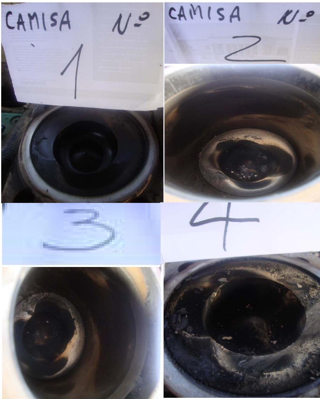
Figura 30. Fotografías de las camisas del motor Deutz F4L912 al terminar todas las pruebas con biodiesel
