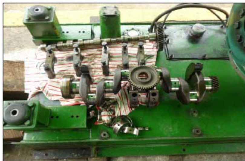
Figura 8. Inspección de los cojinetes del motor
