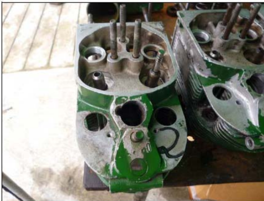
Figura 13. Reacondicionamiento de los cabezotes del motor
