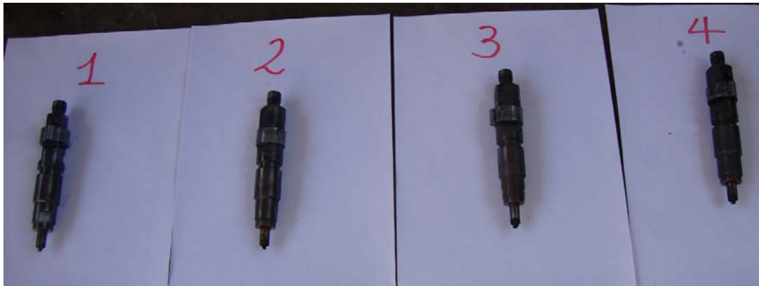
Figura 31. Fotografías de los inyectores del motor Deutz F4L912 al terminar todas las pruebas con biodiesel
