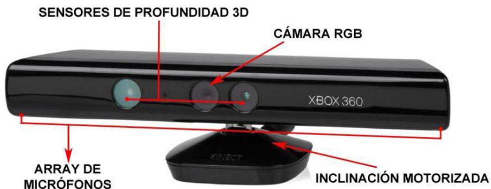
**Figura 22 Elementos del sensor Kinect**
