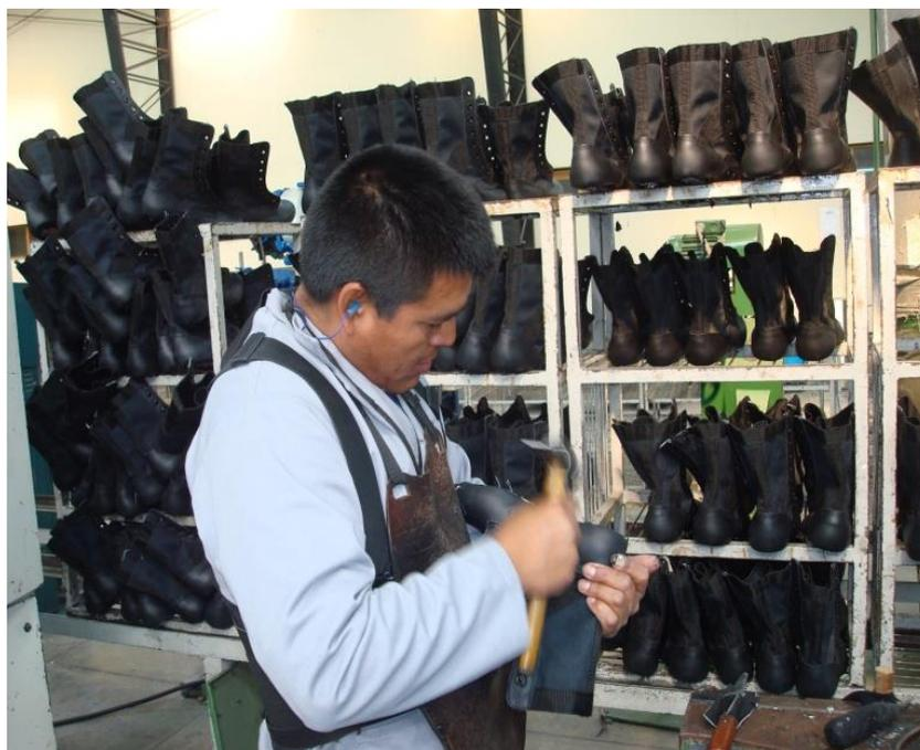
**Figura 30** MANUAL Asentar armado y cortar los sobrantes
