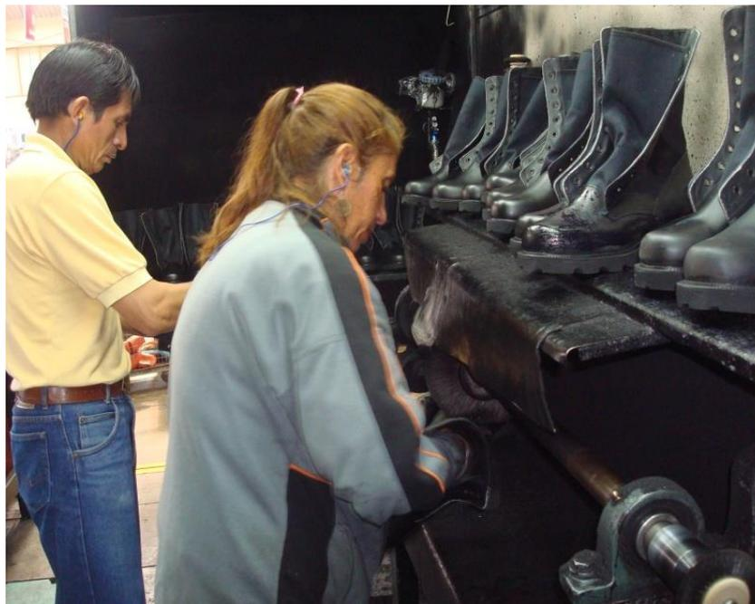
**Figura 46** MAQUINA 8004703000322 Abrillantado de botas (mascarilla)
