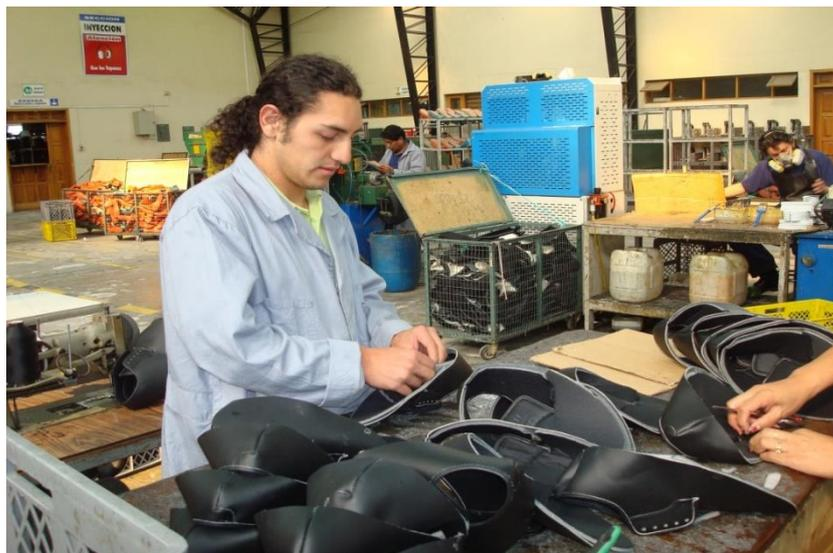
**Figura 19** MANUAL Marcar con compás y pegado de botas
