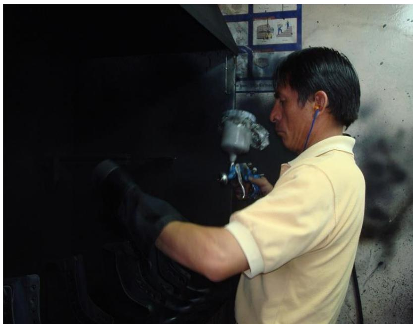
**Figura 47** MANUAL (CON SOPLETE) Lacado de Botas (mascarilla)
