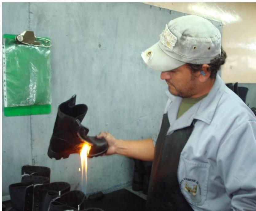
**Figura 44** MANUAL Quemada de hilos (guantes)
