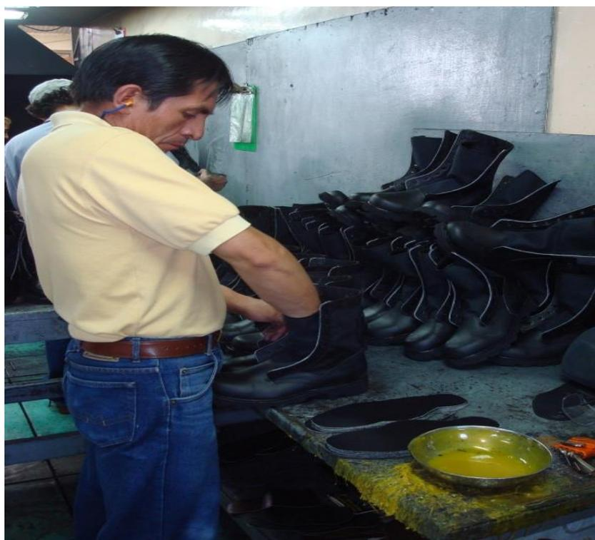
**Figura 43** MANUAL Colocar plantillas (mascarilla, lentes de protección)
