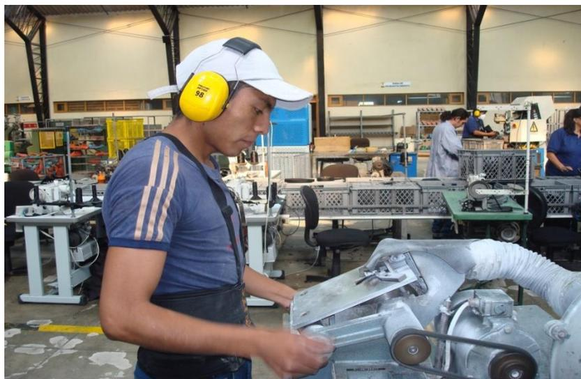
**Figura 14 DESBASTADORA 80047030000512** Desbasta las punteras
