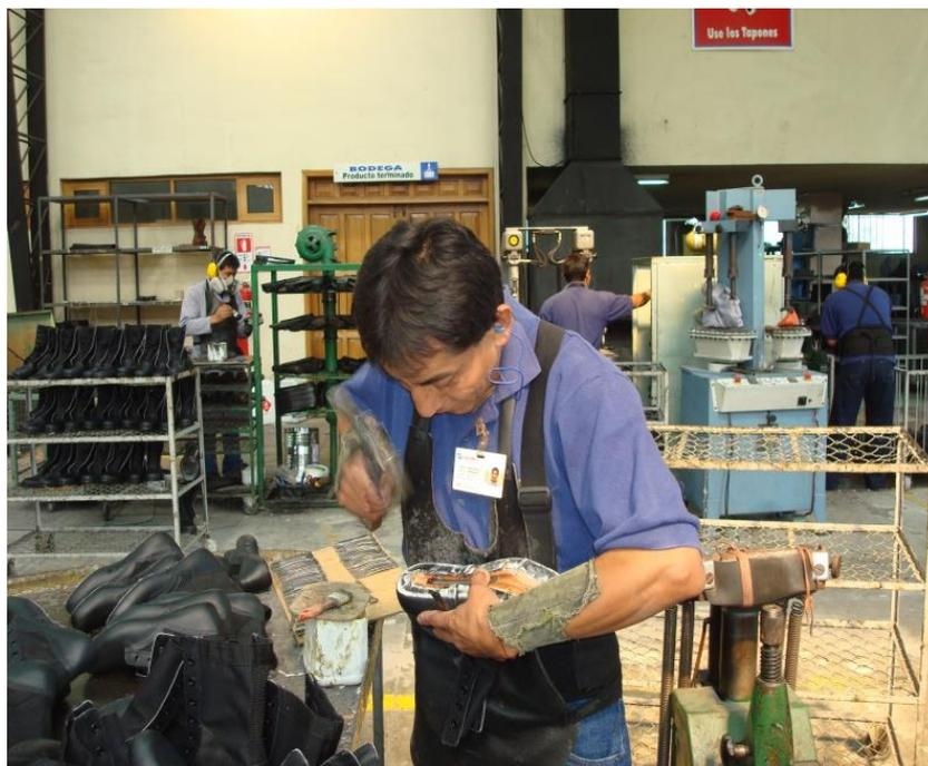
**Figura 35** MANUAL Clavar los cabriones sobre las armadas
