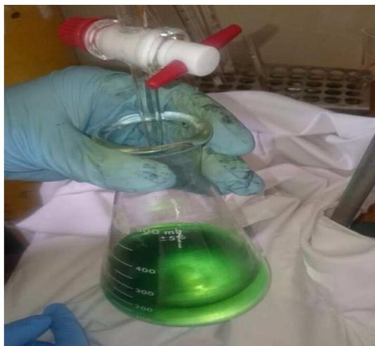
**Figura 37: Titulación con sulfato ferroso FeSO<sub>4</sub>·7H<sub>2</sub>O y cambio de color a verde claro.**
