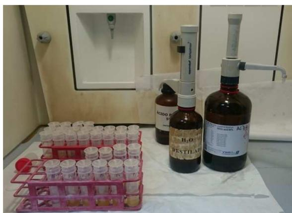
Figura 23: Muestras en reposo con  $\text{HNO}_3$  concentrado.
