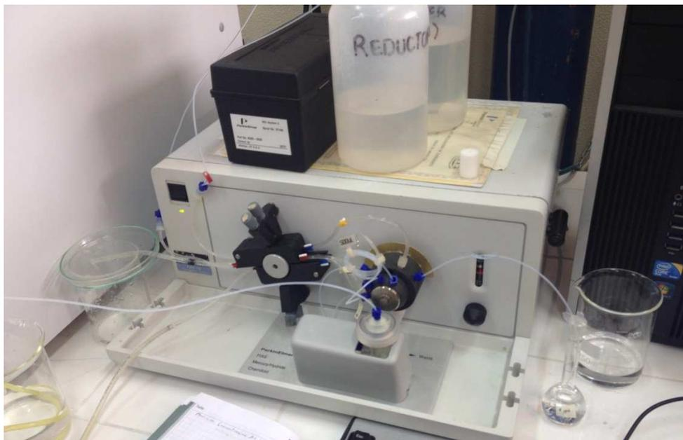
**Figura 20: Medición de los estándares para curva de calibración en FIAS.**
