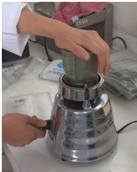
**Figura 15: Muestras de suelo siendo trituradas con la ayuda de una licuadora.**
