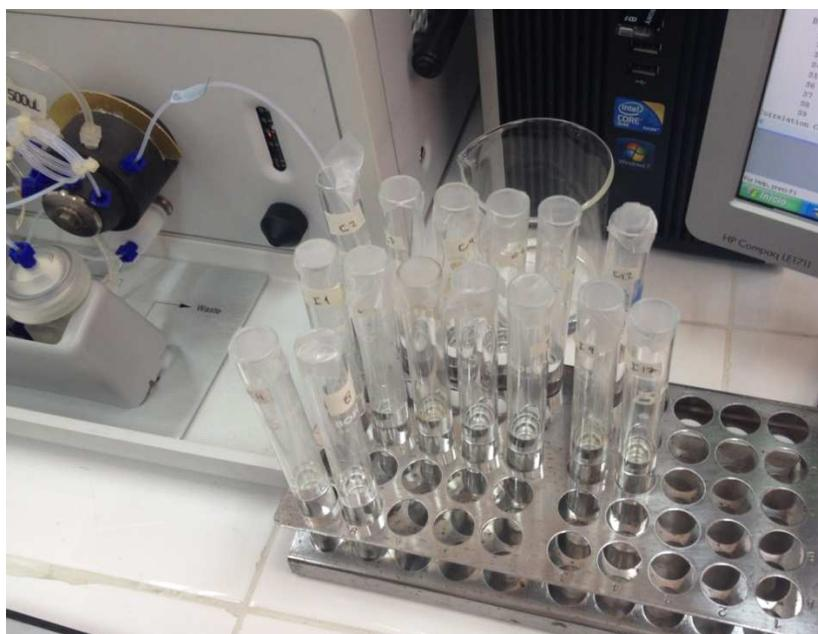
**Figura 22: Medición de las 14 muestras de agua en FIAS.**
