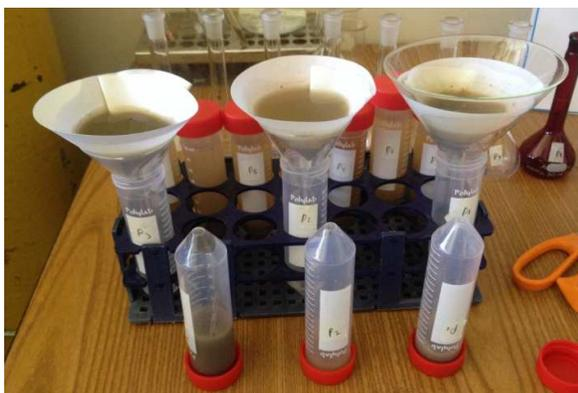
**Figura 30: Filtración de muestras usando papel Whatman 42.**
