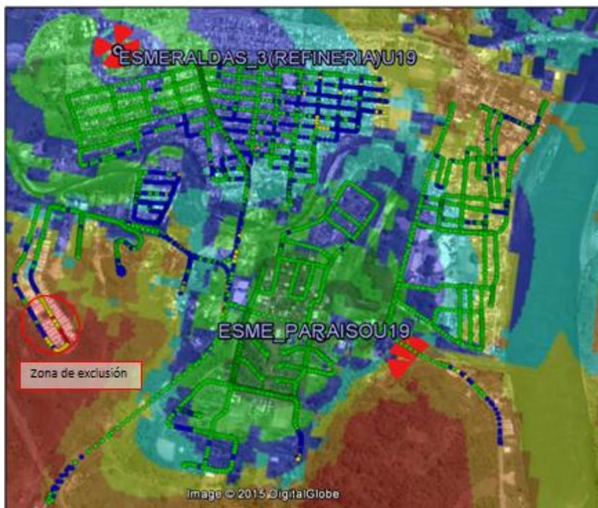
Figura 54. Predicción de la estación base celular ESME\_PARAISO.
