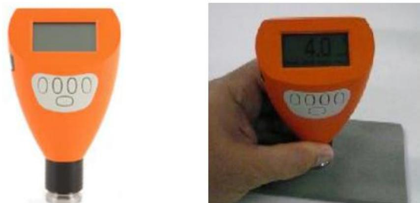
**Figura 33** Medidor digital del perfil de rugosidad
