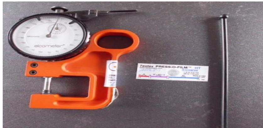
**Figura 29 Equipo de medición de rugosidad**
