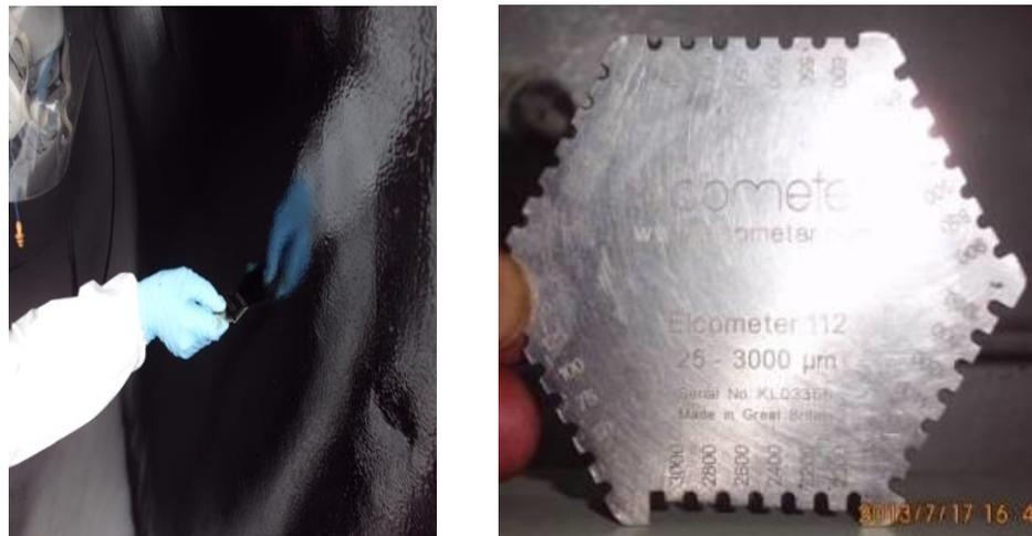
**Figura 40 Medición espesor película húmeda**
