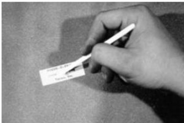
**Figura 30 Cinta testex y herramienta plástica de punta redonda**
