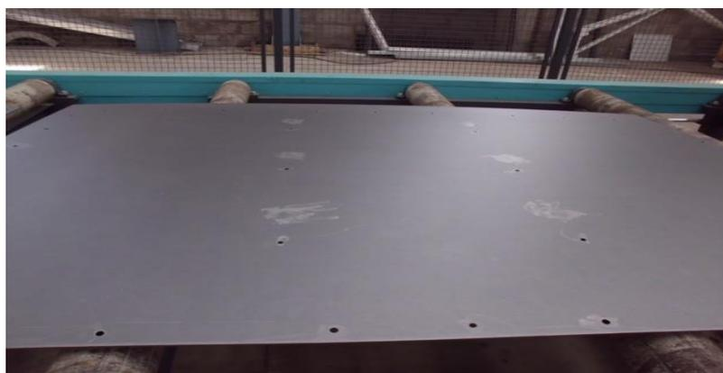
**Figura 28 Limpieza con aire seco**
