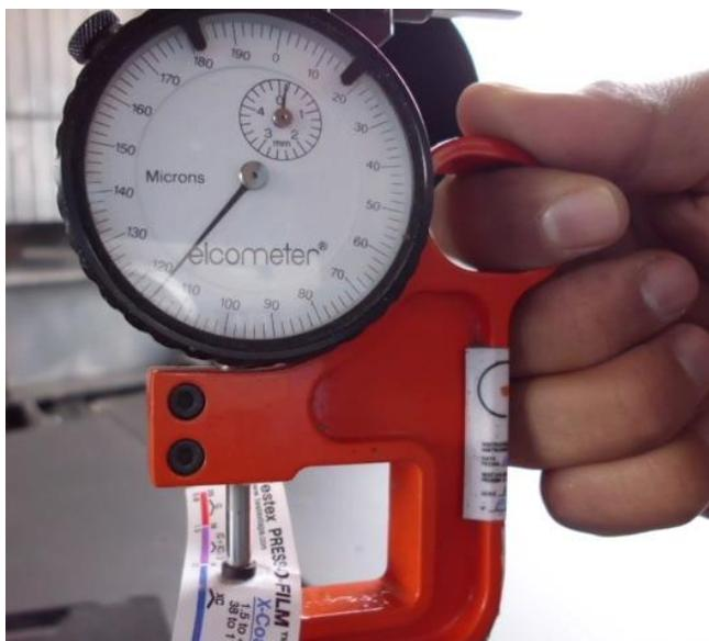
**Figura 32** Medición con el micrometro y la cinta
