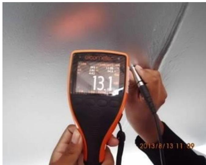
**Figura 41** Medidor de espesores de película seca
