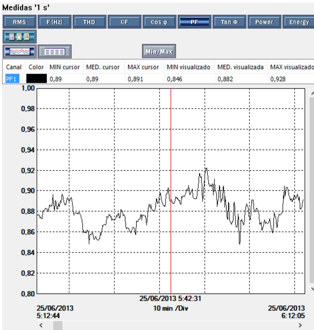
**Figura 5.10. Primer Registro – Factor de Potencia**
