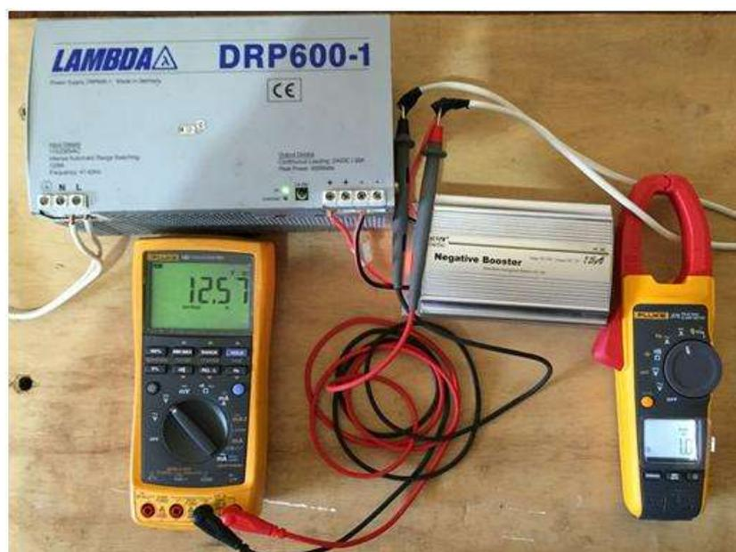
Figura 4.34. Equipos de Medición utilizados para las pruebas a 12 VDC
