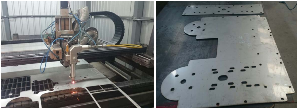
Figura 75. Corte CNC Láser de los componentes de la base
