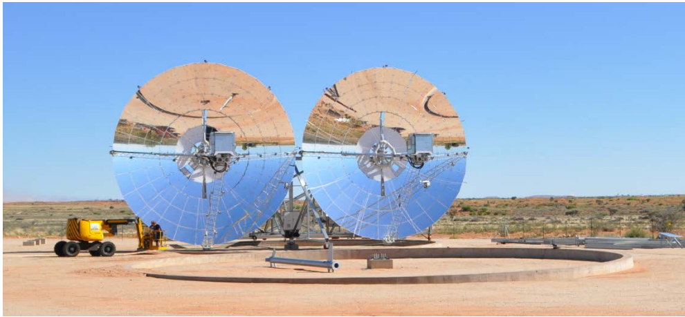
Figura 22 Sistemas de seguimiento de un sistema colector solar – generador Stirling Ripasso Energy
