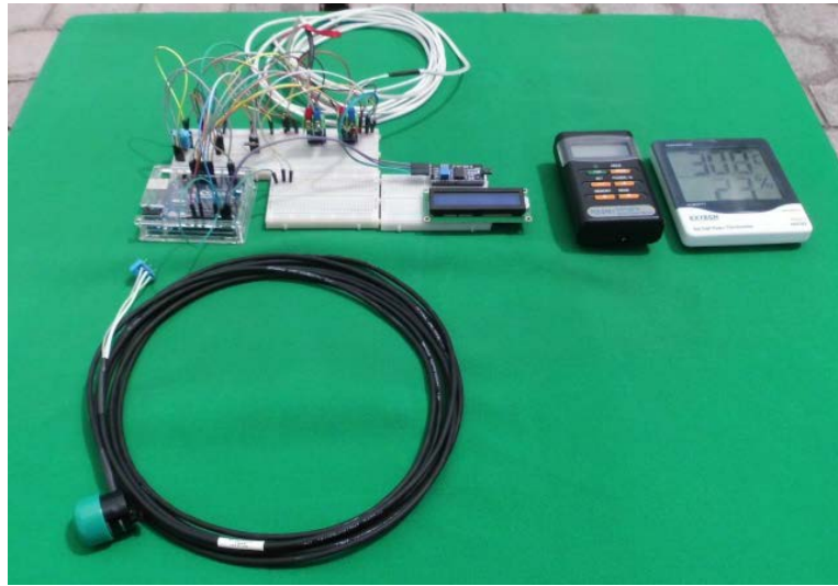
Figura 88. Verificación de exactitud Piranómetro SP-212
