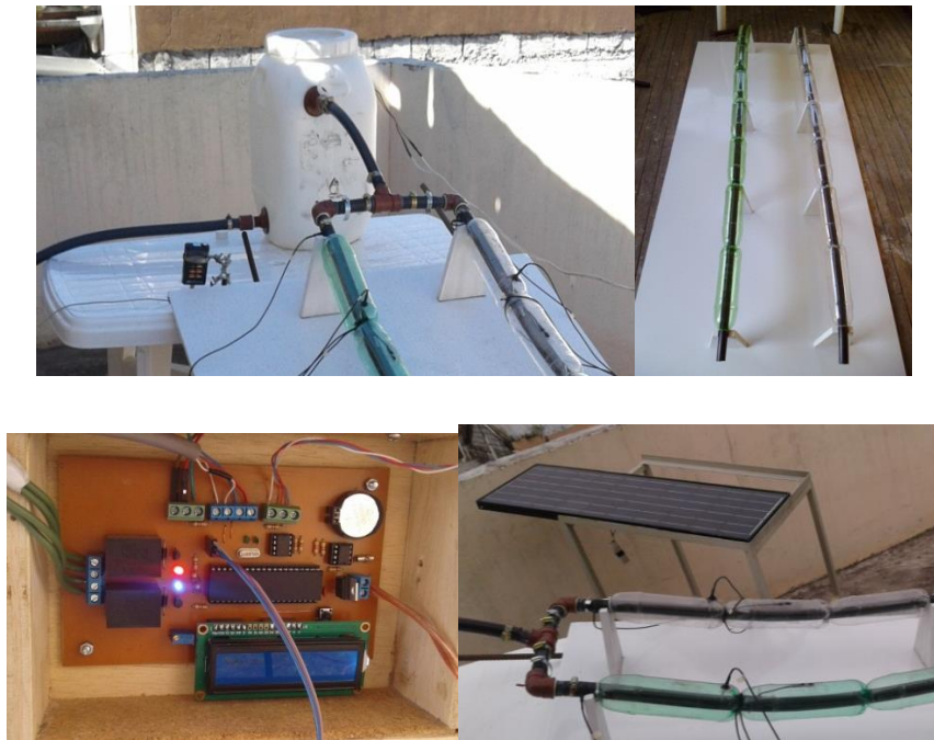
Figura 30 Prototipo experimental para pruebas térmicas del calentador de PET
