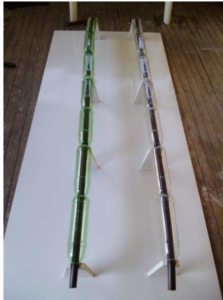
Figura 22 Calentador solar con PET verde y transparente
