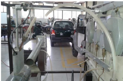
Figura 24 Tubo PVC para el Paso de Combustible
