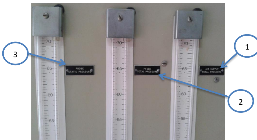
1. Probeta de Presión de Suministro de Aire para Estatorreactor y Pulsorreactor; 2. Probeta de Presión Total; 3. Probeta de Presión Estática
