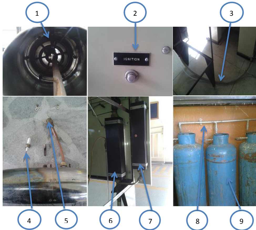
1. Disco Inyector de Gas; 2. Botón de Encendido de Bujía; 3. Manguera de Flujo de Gas; 4. Bujía de Electrodo Largo; 5. Tubería de ingreso de Gas hacia el motor; 6. Caudalímetro para Estatorreactor; 7. Caudalímetro para Pulsorreactor; 8. Tubería de Conducción de Gas; 9. Tanques de Suministro de Gas de 45Kg
