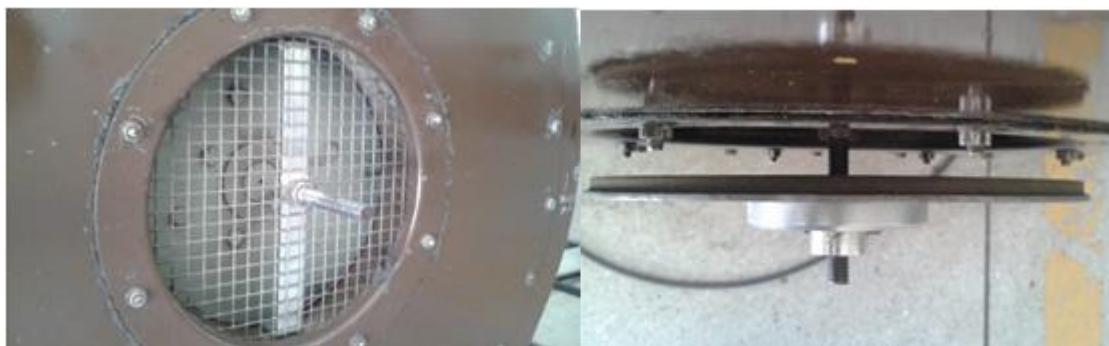
Figura 17 Rueda de Ingreso de Aire para el Compresor
