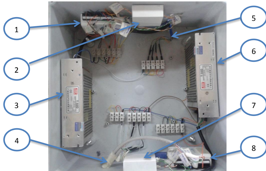
1. Tarjeta NI USB-6008 N°1; 2. Filtros Pasa Bajos de Sensores LM35; 3. Fuente de Poder; 4. Cable UTP de Conexión para Sensores; 5. Cable UTP para Conexión de Sensores; 6. Fuente de Poder; 7. Circuito de Acondicionamiento del FSR; 8. Tarjeta NI USB-6008 N°2
