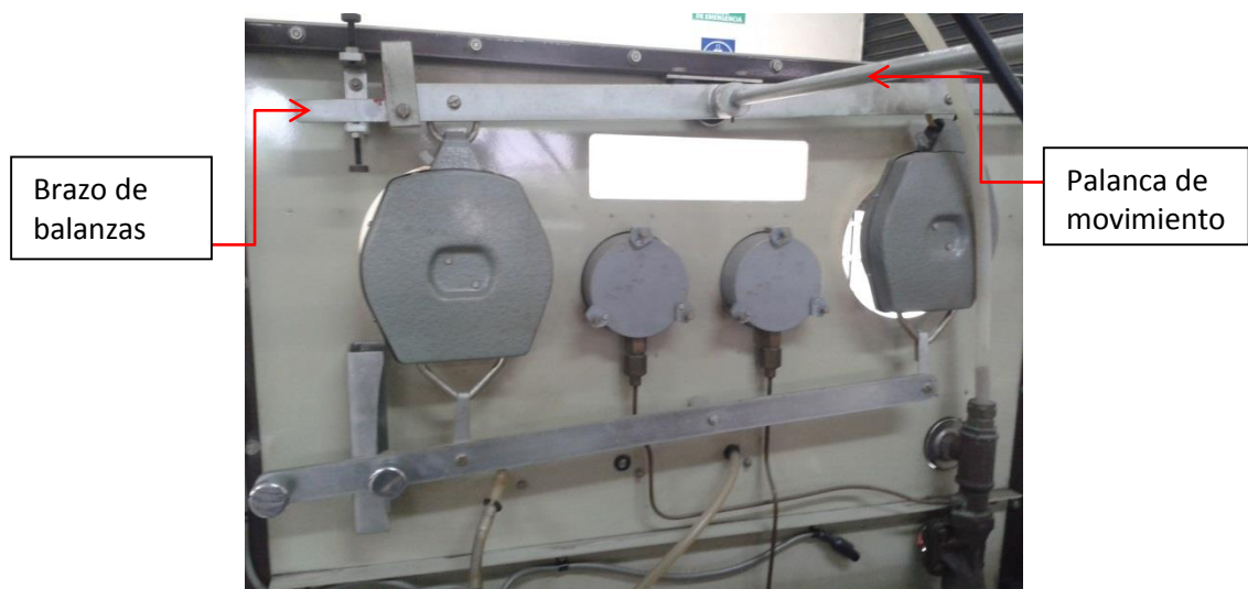
Figura 34 Sistemas de Palancas para el Movimiento de Balanzas.
