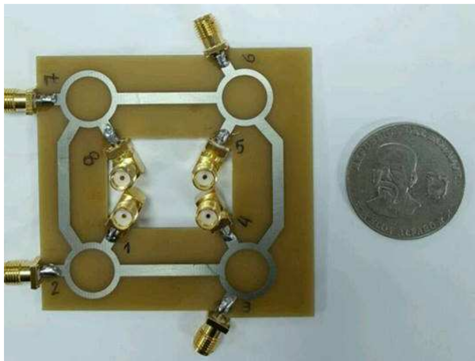
Figura 57 Acoplador direccional Híbrido de 180^\circ 4x4 a 6 GHz implementado
