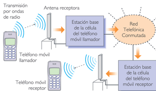
Figura 1 Esquema de Red de Telefonía Móvil
