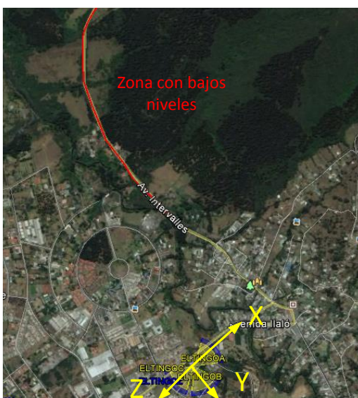
Figura 113 Distribución de sectores en radiobase ELTINGO
