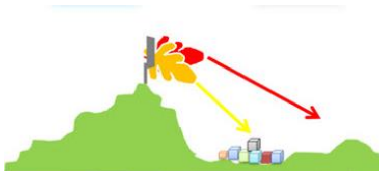
Figura 38 Representación de Downtilt Fuente: (Jelsoft Enterprises, 2017)
