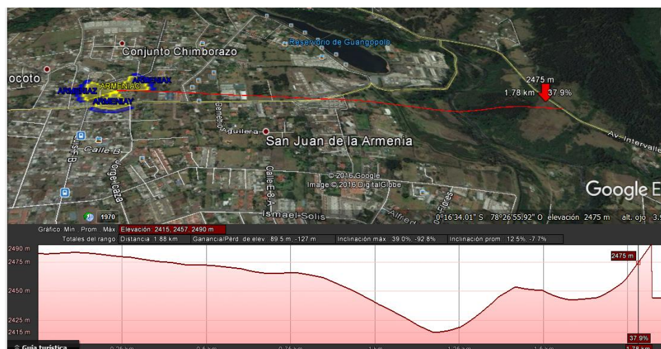
Figura 88 Perfil de relieve desde ARMENIA hacia Zona 3 de baja cobertura UMTS
