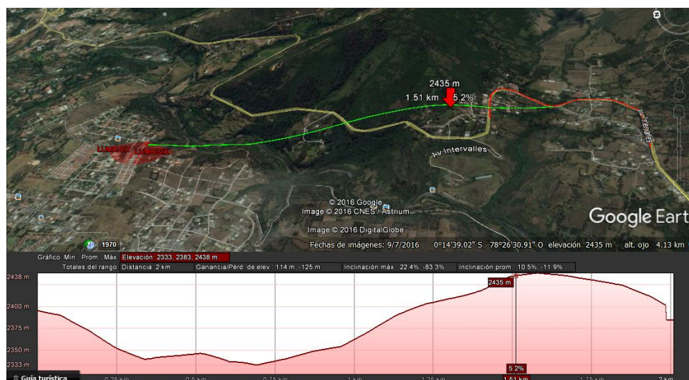
Figura 78 Perfil de relieve desde LUMBISÍ hacia Zona 2 de baja cobertura GSM
