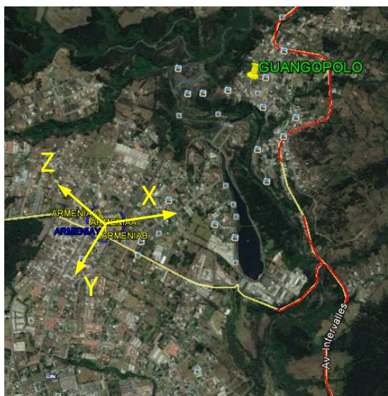
Figura 107 Distribución inicial de sectores en radiobase ARMENIA
