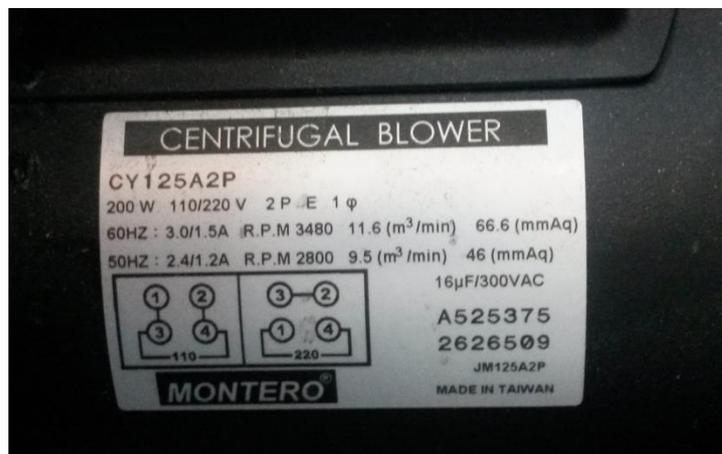
**Figura 36. Características del ventilador centrífugo CY1250A2P.**
