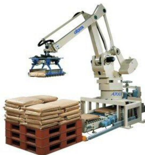
**Figura 4:** Sistema de paletizado robótico – Robot Articulado.
