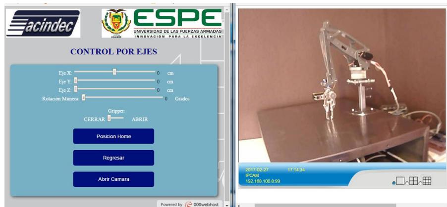
**Figura 107:** Interfaz para el control por ejes.
