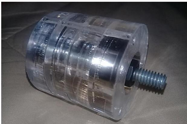
**Figura 81:** Ensamble rodillos, rodamientos y eje.
