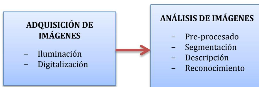
**Figura 5:** Etapas de un sistema de visión artificial.
