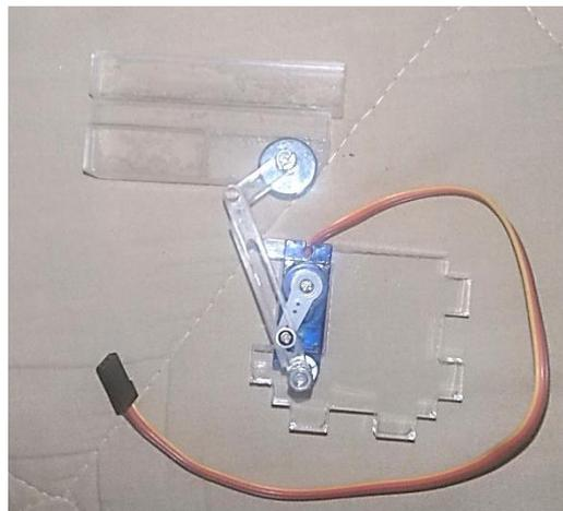
**Figura 87:** Ensamble sistema de empuje
