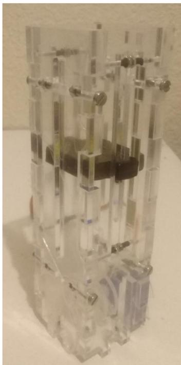
**Figura 90:** Ensamble final dispensador piezas "B"
