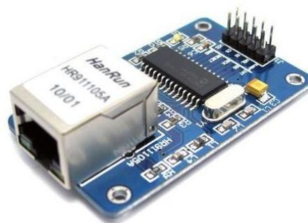
**Figura 7:** Módulo Ethernet.
