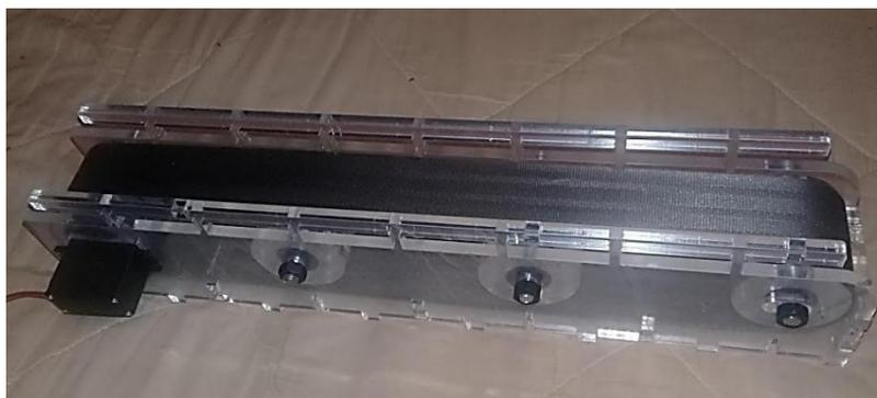
**Figura 84:** Ensamble final banda transportadora.
