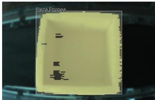
**Figura 113:** Detección de piezas errónea con la PIXY cam.
