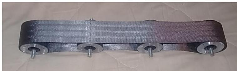
**Figura 83:** Ensamble entre rodillos y banda transportadora.
