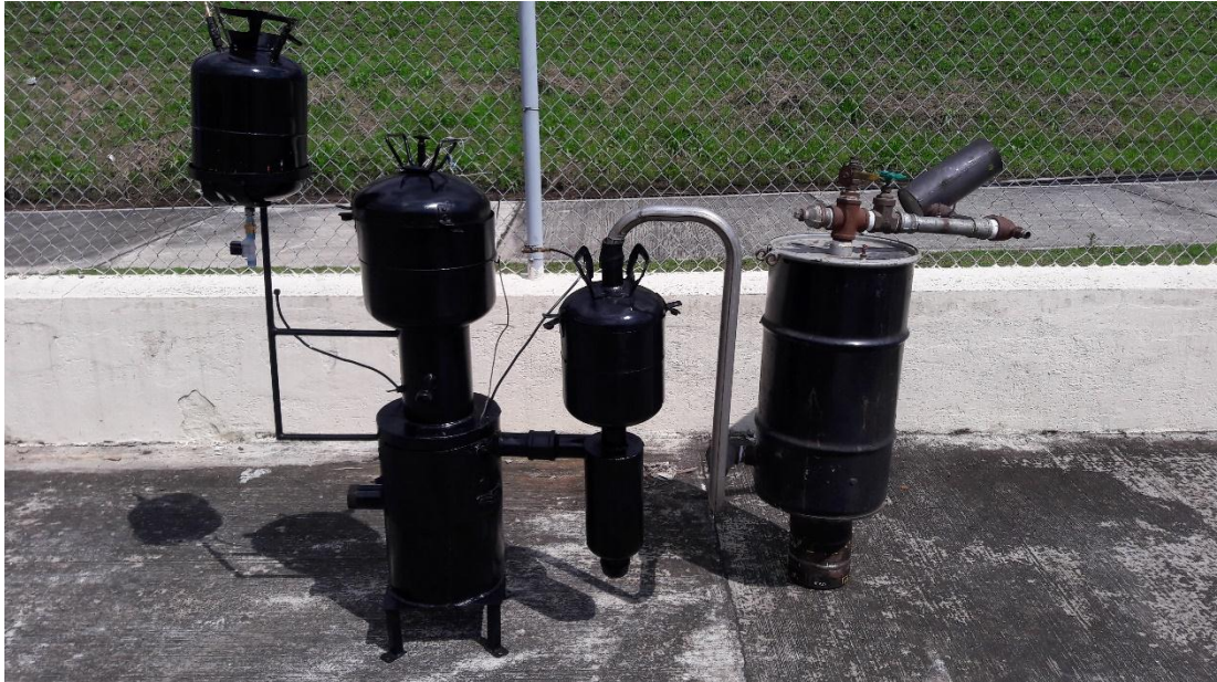
Figura 20 Gasificador con un nuevo sistema de filtrado y transmisión de gas
