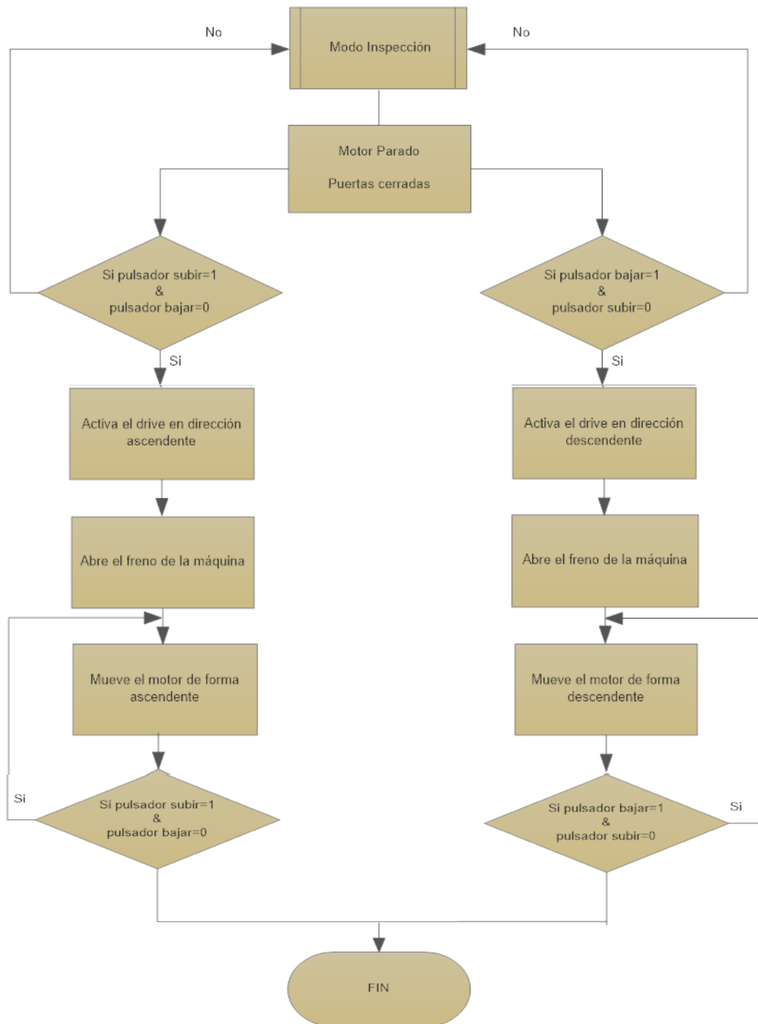
Figura 50. Diagrama de flujo maniobra de inspección de un ascensor
