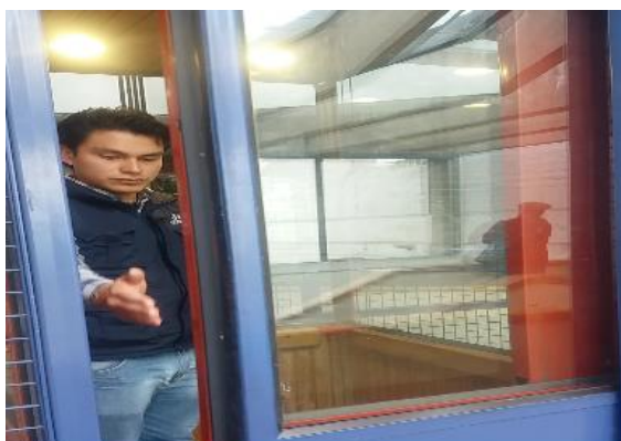
Figura 72. Prueba de cortina de luz del ascensor
