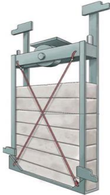
Figura 10. Chasis de contrapeso de ascensor
