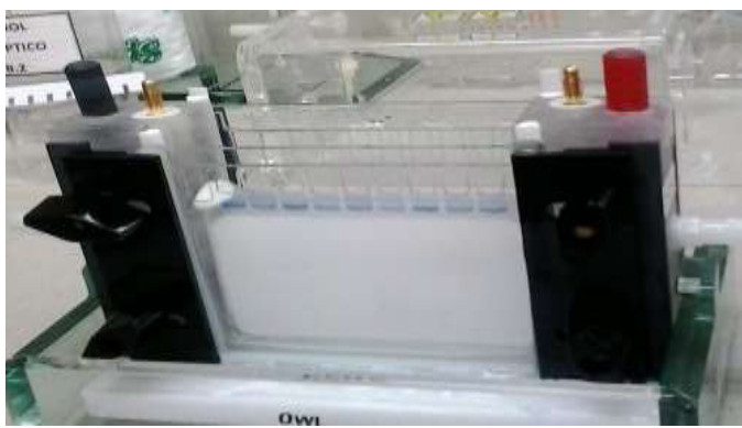
Figura 7 Instalación, preparación y aplicación de muestras en la cámara de electroforesis.
