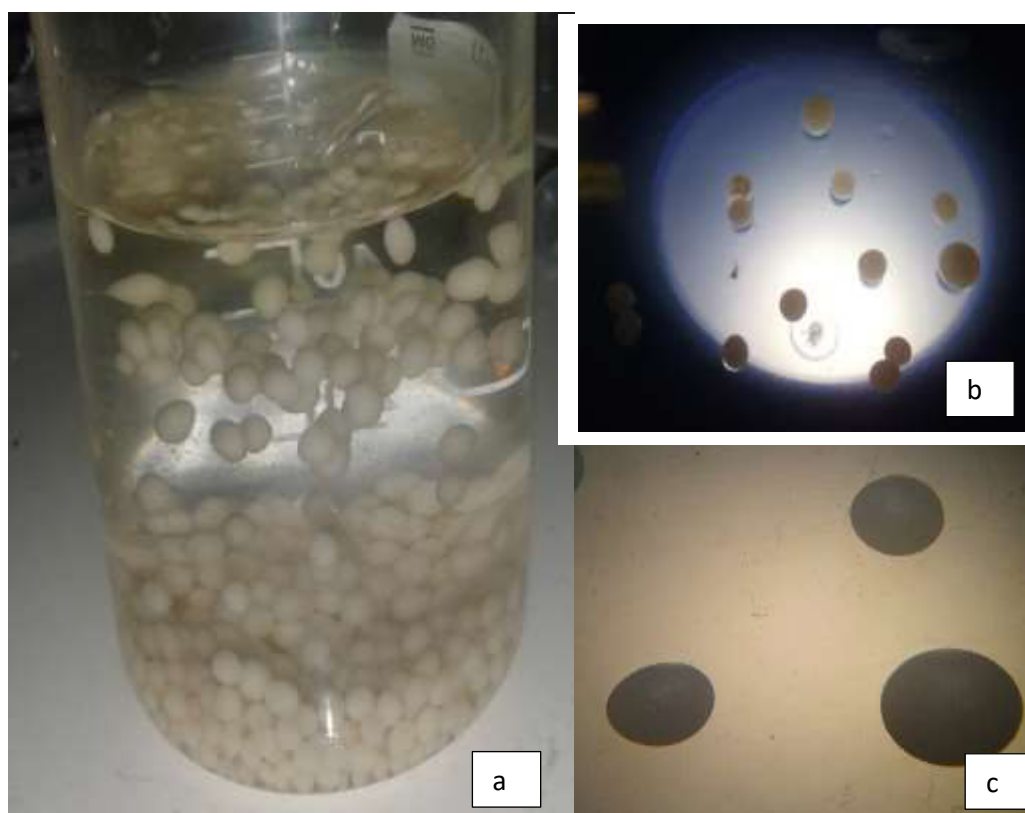
Figura 15 Biocatalizador de células inmovilizadas productoras de FTF.
