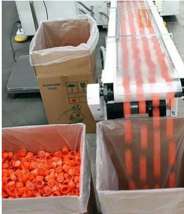
**Figura 11: Cinta transportadora de producto terminado**
