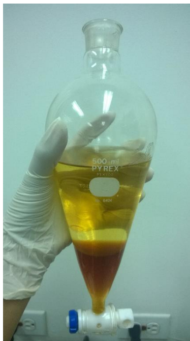
Figura 15. Separación de biodiesel y subproductos
