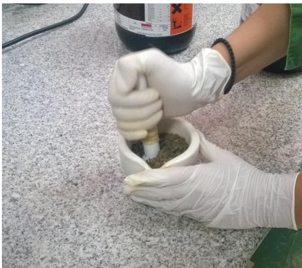
Figura 13. Destrucción mecánica de biomasa seca en mortero
