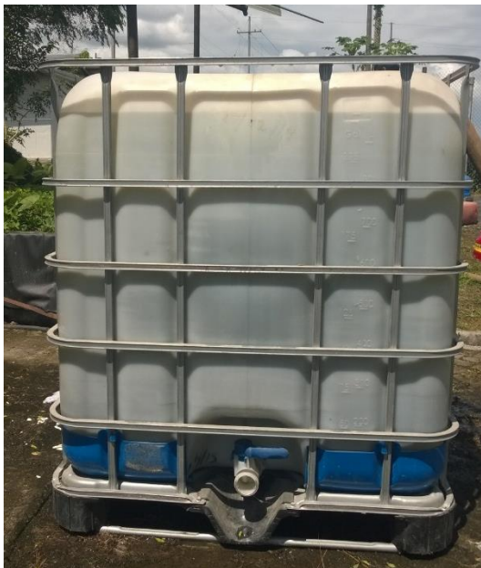
Figura 9. Bulk tank de 1000 L de capacidad adecuado como fotobiorreactor
