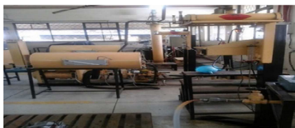
Figura 90: Banco de pruebas para la medición del flujo másico de combustible.
