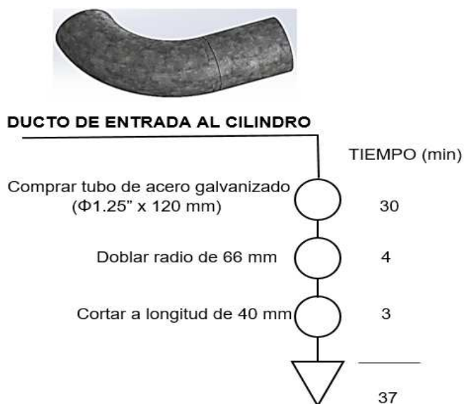
Figura 68: Proceso para la fabricación del ducto de entrada al cilindro.
