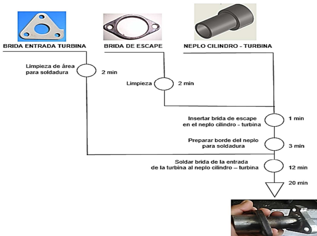
Figura 63: Procesos para la fabricación del acople cilindro - turbina.
