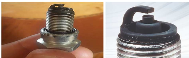
Figura 79: Presencia de carbonilla en la bujía de la motocicleta sin sobrealimentar.
