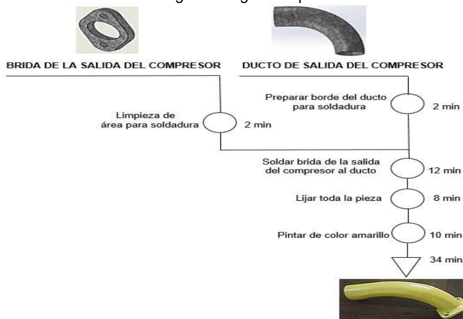
Figura 67: Proceso para la fabricación del ducto de salida del compresor – brida.
