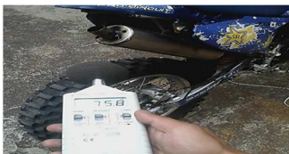
Figura 92: Medición del nivel de ruido con el sonómetro Thomas Scientific.
