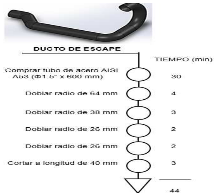
Figura 64: Procesos para la fabricación del ducto de escape.
