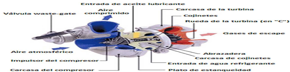
Figura 20: Elementos que componen el turbocompresor de geometría fija.
