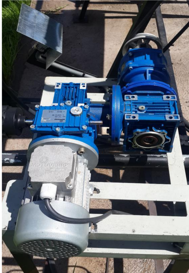
Figura 36: Equipo Motoreductor con 4 etapas de reducción acoplado al sistema
