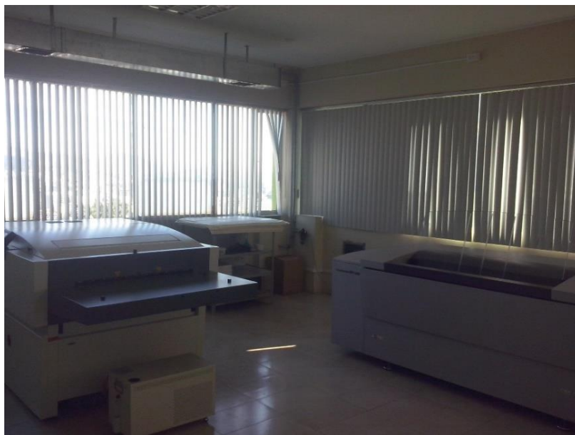
Figura 36. Izq. Procesadora de placas Glunz & Jensen 85 HDX Derecha. CTP Kodak Trendsetter 800 UHR.
