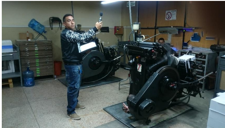
Figura 20. Medición de ruido Numeradora Vertical.
