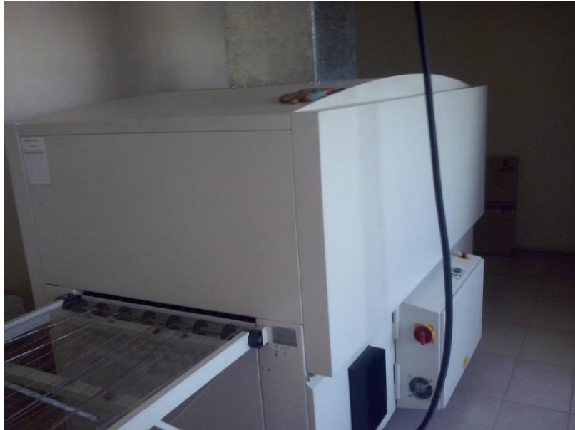
Figura 35. Horno de secado de placas Glunz & Jensen PBO 85.
