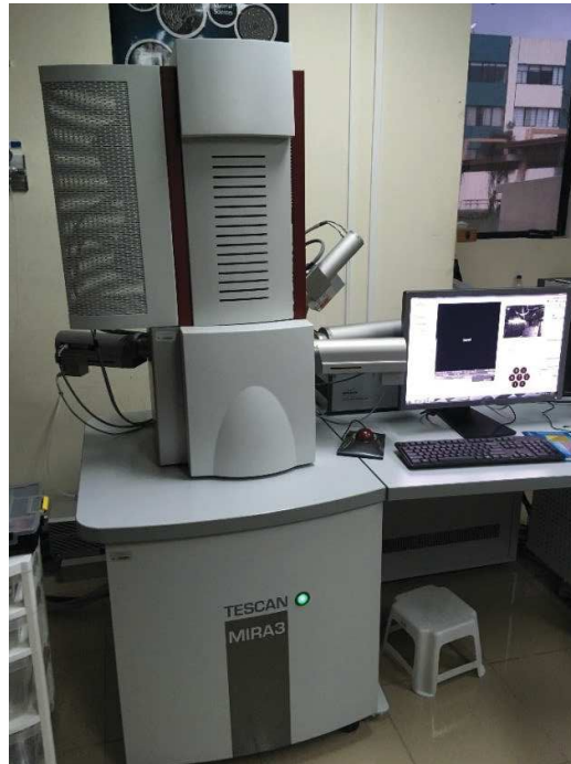
Figura 37: Microscopio electrónico de barrido de emisión de campo (FE-SEM) Marca Tescan modelo MIRA 3 LMU.
