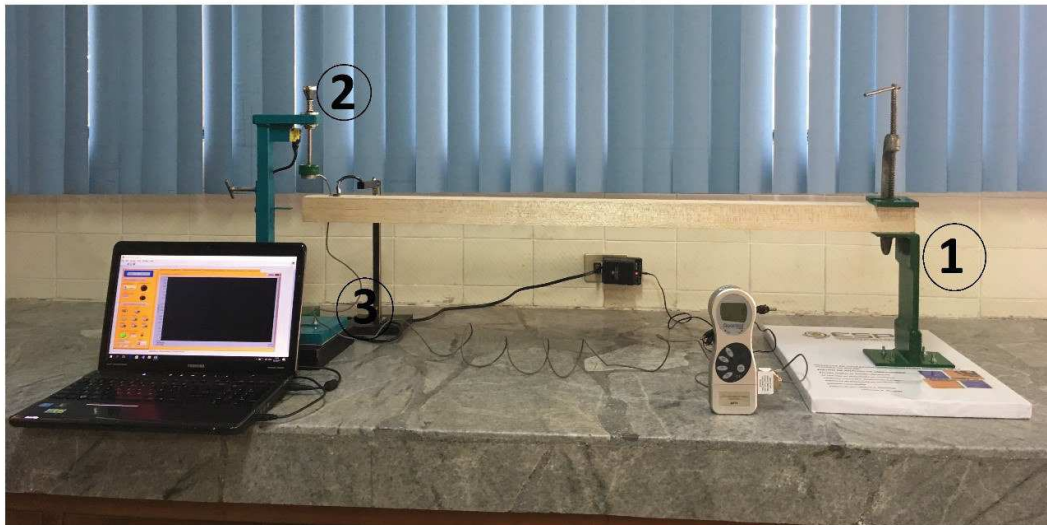
Figura 40: Esquema de partes equipo de ensayos bajo régimen dinámico
