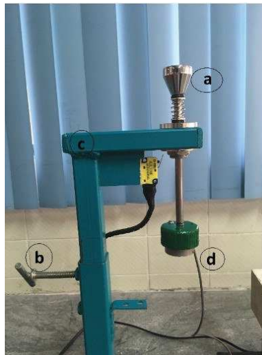
Figura 42: Partes del sistema de Fuerza.
