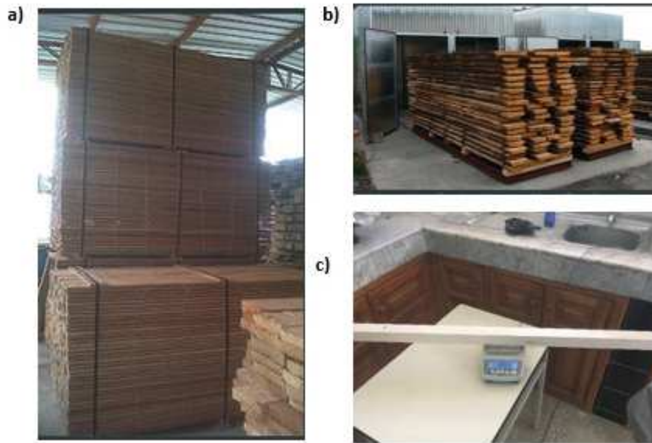
Figura 34: a) Tablones secados al medio ambiente, b) ingreso de los tablones al horno eléctrico, c) Pesado de las probetas con CH 12 %
