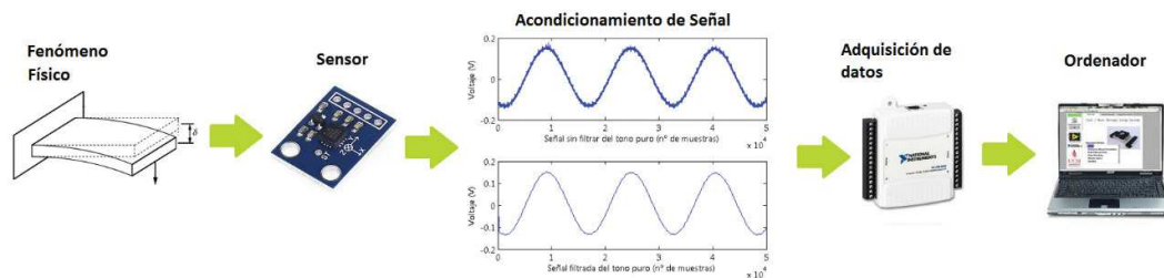
Figura 26: Esquema de adquisición de datos
