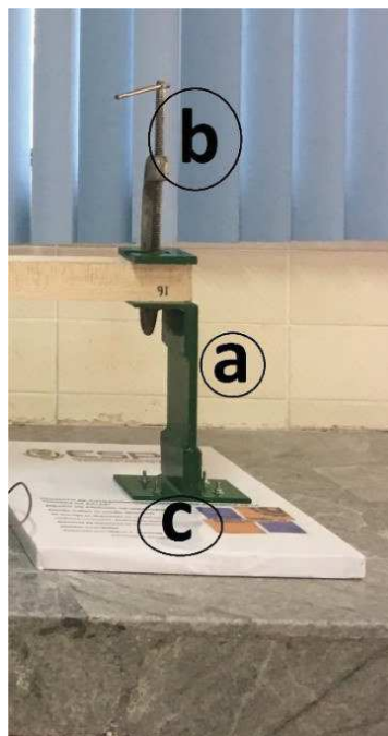
Figura 41: Esquema de partes del sistema de sujeción.
