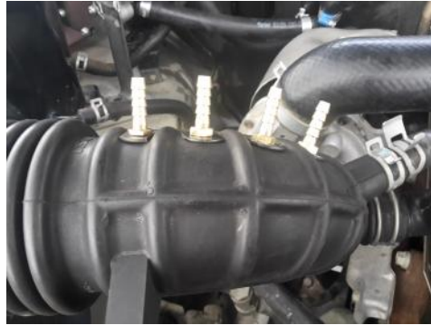
Figura 23 Perforaciones en el ducto de alimentación.
