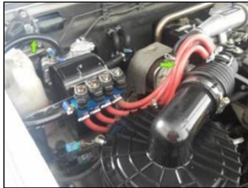
Figura 22 Tuberías de baja presión.
