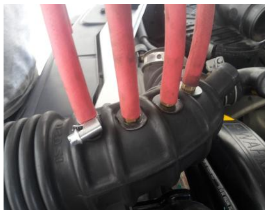
Figura 24 Fijación de las mangueras de baja presión
