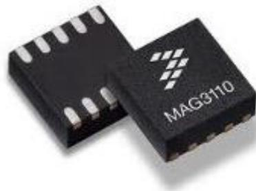
**Figura 14. Magnetómetro de 3 ejes**
