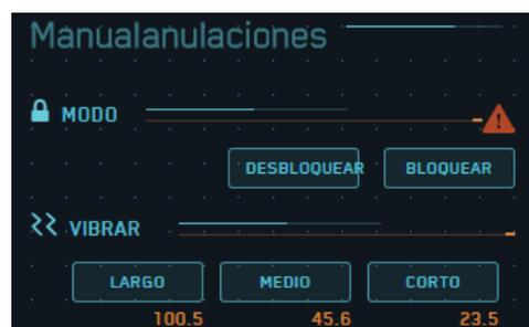
Permite bloquear o desbloquear el brazalete sin la necesidad de usar el gesto de doble pulso, sino mediante un clic, además existe la función vibrar, donde se puede probar los tres niveles de intensidad del motor vibrador interno del brazalete, con solo dar un clic sobre el tipo de vibración que se desee probar, en cada uno de los tres niveles se especifica la duración de la vibración en milisegundos.
