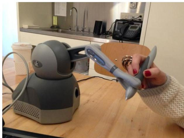
**Figura 6. Dispositivo Geomagic-touch**
