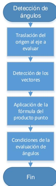
**Figura 33 Diagrama de flujo de detección de ángulos**
