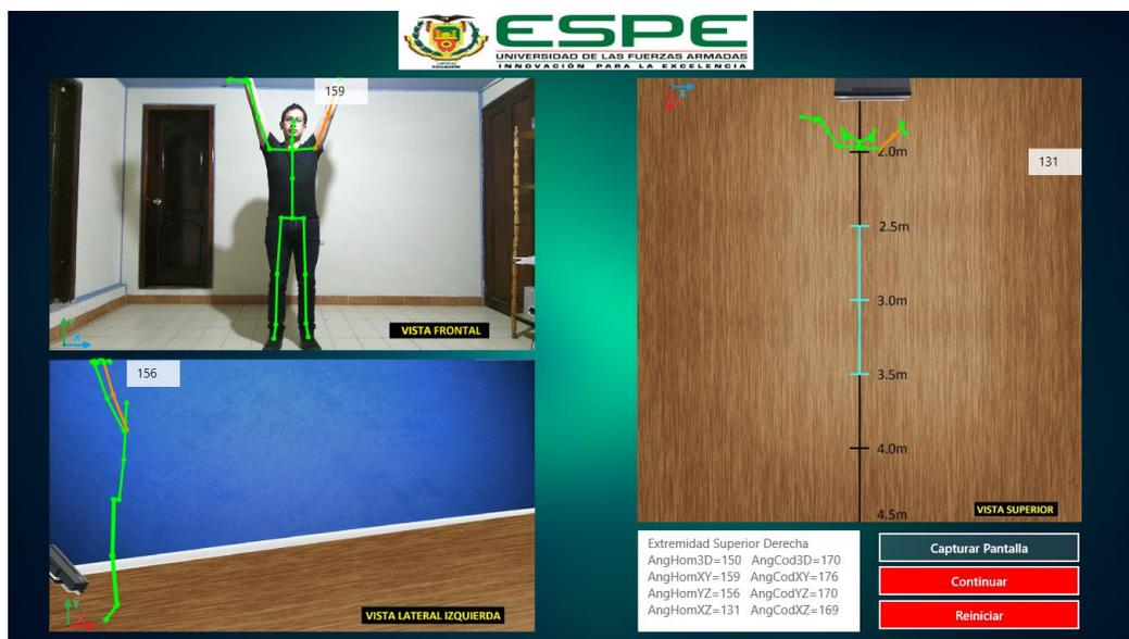
**Figura 64 Detección incorrecta de las extremidades superiores**
