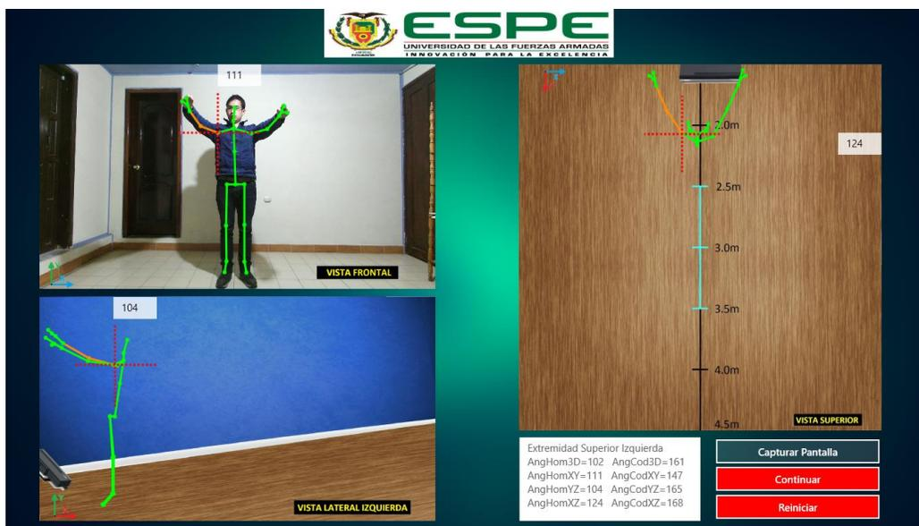
**Figura 46 Sincronización correcta entre PC - Kinect 2.0**
