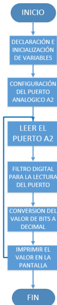
Figura 45: Diagrama de flujo para la medición de RTDS de 2, 3 y 4 hilos.
