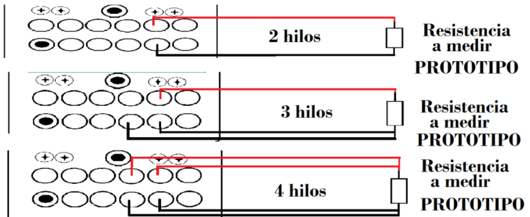
Figura 60: Conexión para la medición de RTDS de 2, 3 y 4 hilos.
