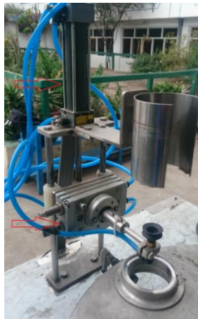
Figura 91. Montaje del cilindro de doble efecto y actuador giratorio.
