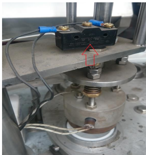
Figura 100. Montaje de los finales de carrera.
