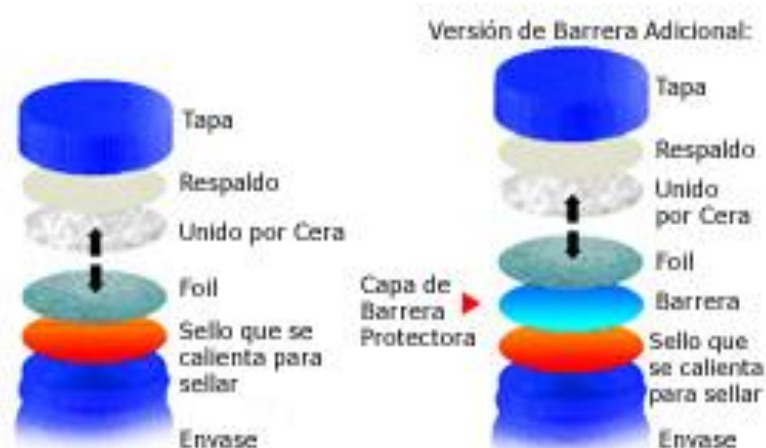
Figura 2. Sello de 2 piezas unidas por cera utilizados para productos volátiles o agresivos.
