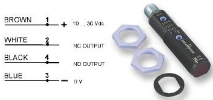
Figura 43. Conexión del sensor
