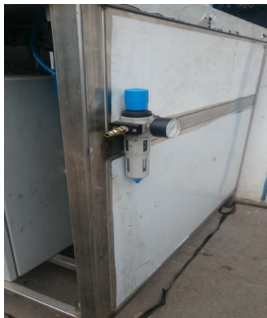
Figura 88. Montaje de la unidad de mantenimiento.
