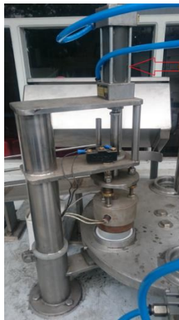
Figura 92. Montaje del cilindro neumático sellador
