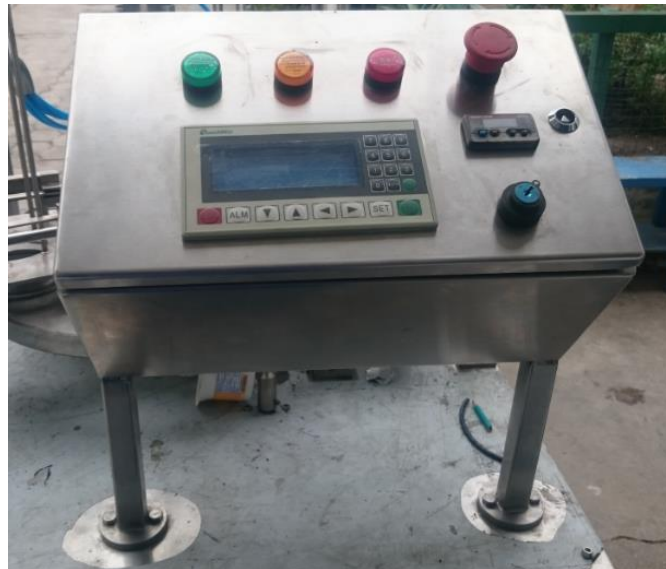
Figura 95. Montaje del tablero de control.
