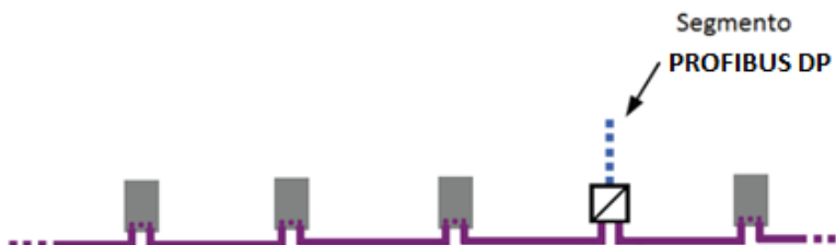
Figura 4 Topología lineal de Profibus DP
