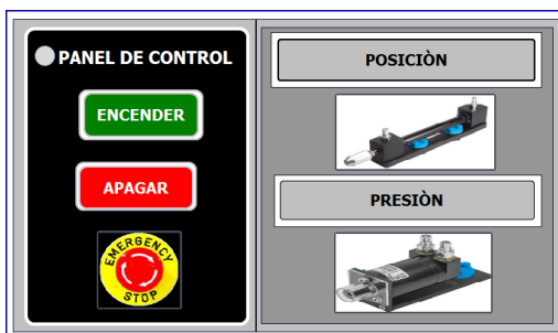
Figura 88 Panel de control para el encendido y apagado del grupo hidráulico.
