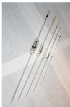
**Figura 8 Pipetas aforadas de distintos tamaños**
