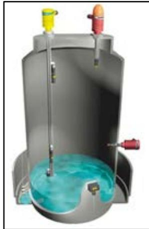
**Figura 20** Control de nivel ultrasónico mediante un sensor FLOWLINE SwitchTek.
