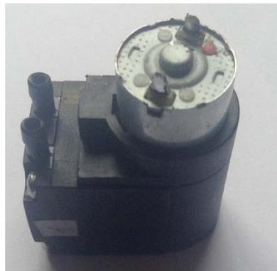
**Figura 43 Bomba de membrana**
