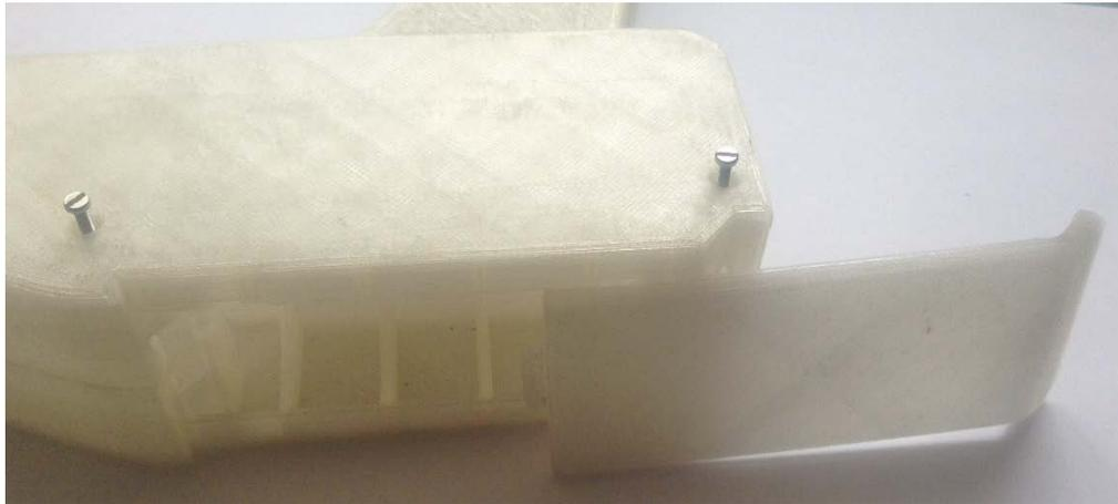
**Figura 113 Compartimiento de la batería**
