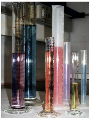
**Figura 6** Probetas de diferentes tamaños
