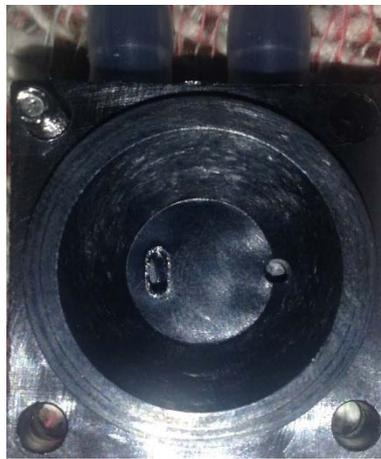
Figura 45 Membrana de la bomba
