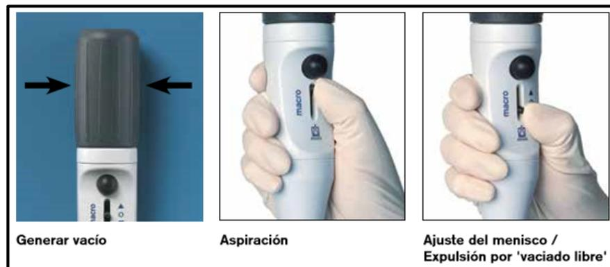
Figura 15 Proceso de manejo de un auxiliar de pipeteado manual.
