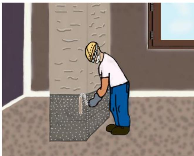
16. Colocar una nueva capa de resina epóxica adhesiva sobre la fibra del tejido CFRP. Con el fin de no dejarla totalmente expuesta a la intemperie.
