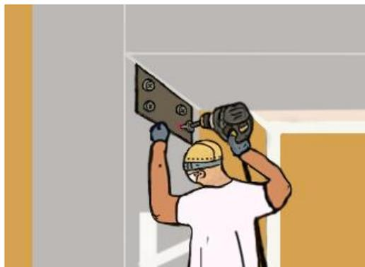
7. El perfil metálico a ser colocado deberá tener orificios previamente realizados en el patín superior para su posterior anclaje. El espaciamiento deberá ser proporcionado por el profesional a cargo del proyecto
