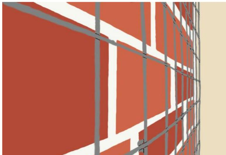
6. Ya colocada la malla se procede al recubrimiento con concreto lanzado, el espesor que tendrá estará dado de acuerdo a las especificaciones en planos. Se recomienda empezar este procedimiento desde la base de la mampostería continuando hasta la parte más alta. El hormigón no deberá tener una consistencia muy fluida, puesto que el mismo tenderá a desmoronarse.
