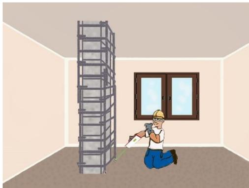
6. Encofrar las columnas y fundir la nueva sección
