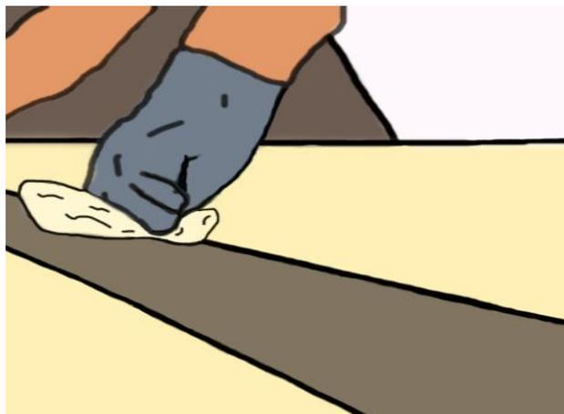
6. Con ayuda de una espátula con labrado aplicar el adhesivo de pegado estructural sobre la Platina de CFRP en un espesor de 1 a 2 mm.
