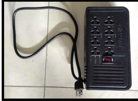
Figura. 27 Regulador de voltaje
