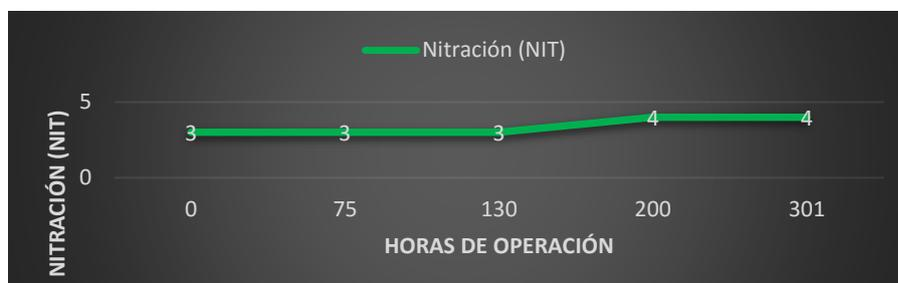
**Figura 19. Nitración (NIT) vs Horas de operación del motor**
