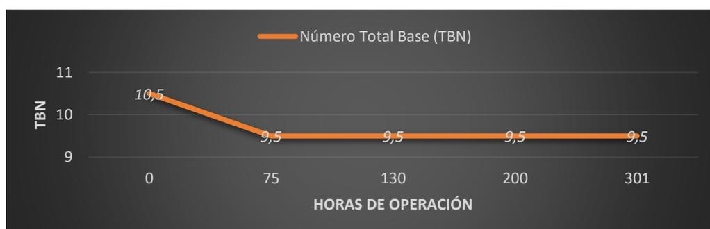
**Figura 22. Número Total Base (TBN) vs Horas de Operación del motor**
