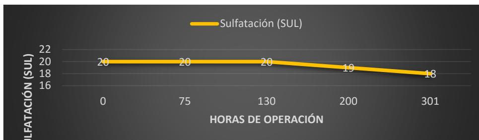
**Figura 20. Sulfatación (SUL) vs Horas de operación del motor**
