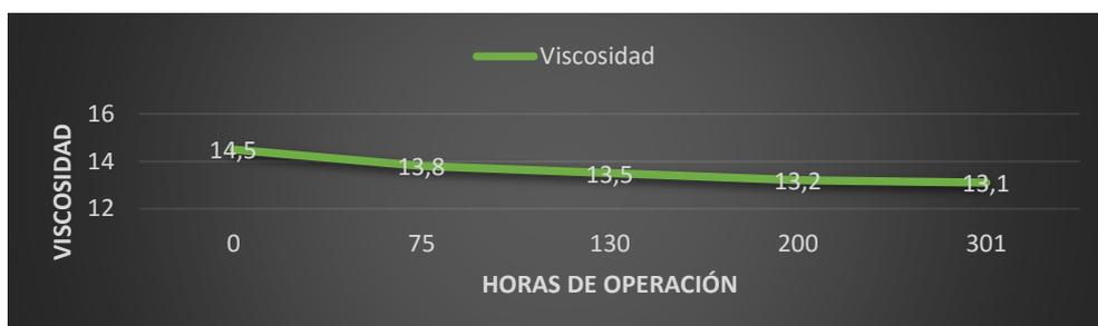
**Figura 21. Viscosidad vs Horas de Operación del motor**
