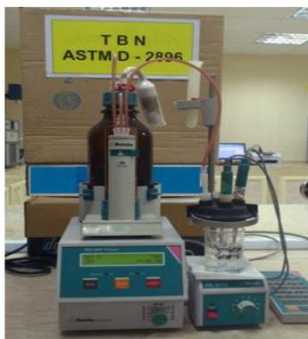
**Figura 6. Titrador Potenciométrico Analizador de TBN o BN**
