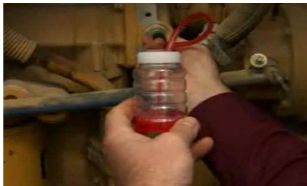
*Figura 5. Técnica del acople rápido*
