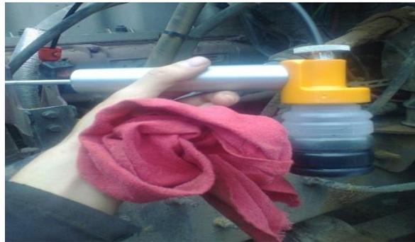
*Figura 4. Extracción del aceite lubricante*
