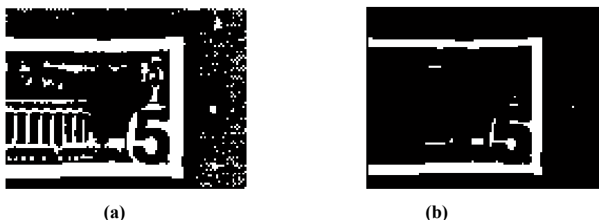
Figura 3.28. Resultado de la erosión de la imagen binaria del billete: (a) Imagen binaria (b) Imagen erosionada
