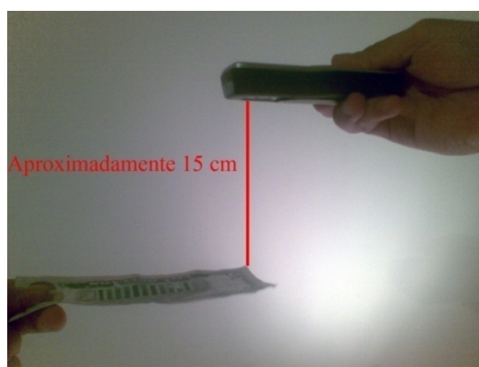
Figura 10. Alineación y distancia correcta del billete a la cámara para su reconocimiento
