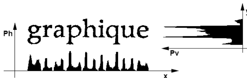
Figura 2.12. Perfil de proyección vertical P_V y horizontal P_H de una imagen
