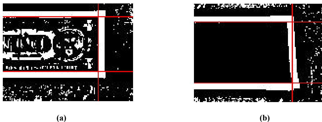
Figura 3.35. Umbralizado del corte de: (a) Un billete, que cumple con las condiciones de la tercera discriminación (b) Un papel vacío, que no cumple con las condiciones de la tercera discriminación
