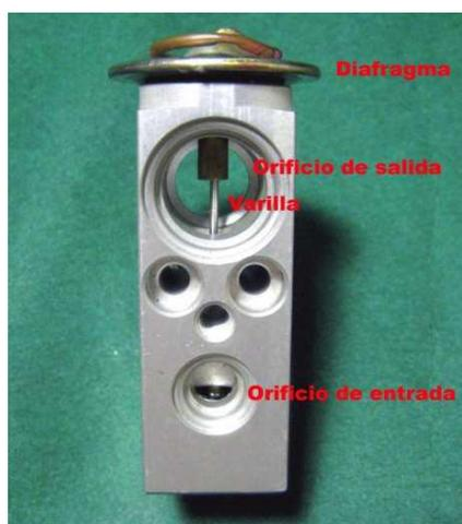
**Figura 6. Válvula de expansión**
