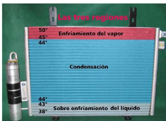
**Figura 4. Condensador con filtro deshidratador y sus regiones**
