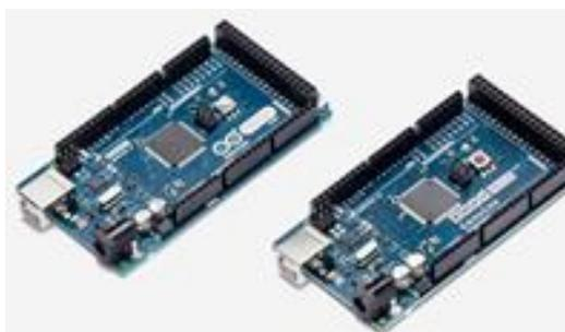
**Figura 28. Arduino mega**
