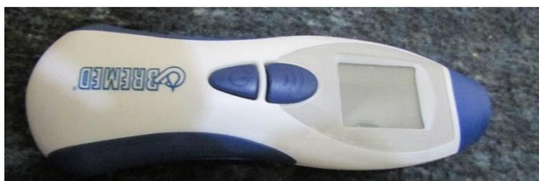
**Figura 57. Termómetro infrarrojo remoto**
