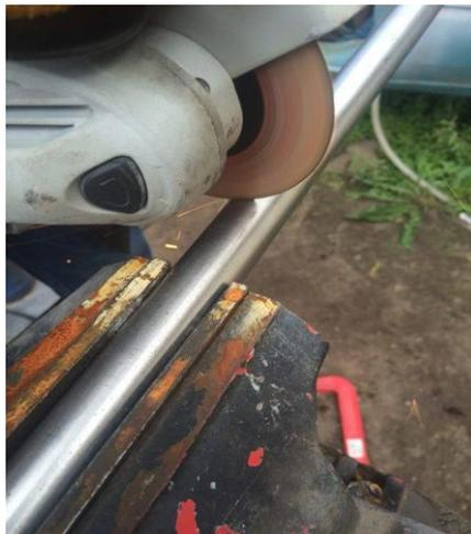
**Figura 26 Cortes realizados en las tuberías**
