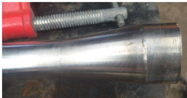
**Figura 30 Acabado final del proceso de soldadura tubería de 1plg**
