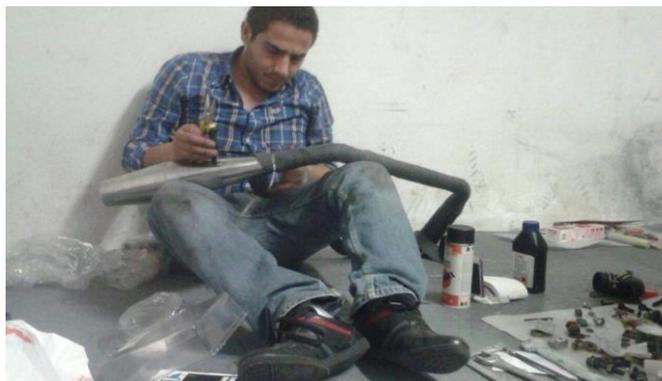
**Figura 41 Colocación de cinta aislante en la salida del escape**
