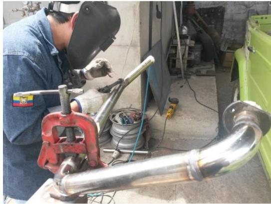
**Figura 39 Acabados finales del colector de escape**
