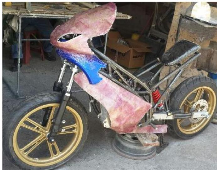
**Figura 23 Carenado frontal ubicado antes de la pintura**
