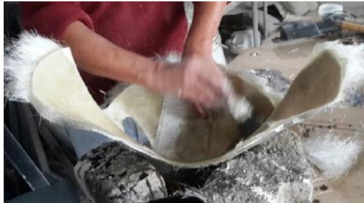
**Figura 22 Colocación de la fibra en el molde de cartón**
