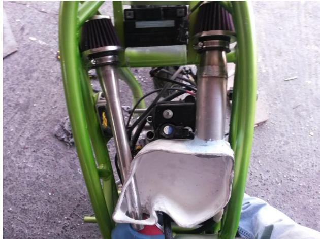
**Figura 34 Sistema Ram- Air colocado en la ubicación propuesta**
