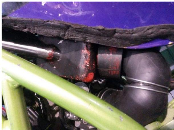
Figura 42 Colocación del sistema Ram- Air
