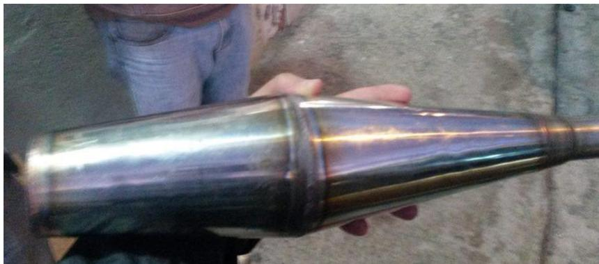
**Figura 40 Muffler con sus acabados finales**
