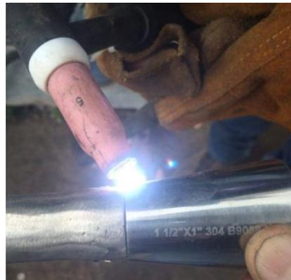
**Figura 29 Proceso de soldadura para la construcción de los conductos de admisión**
