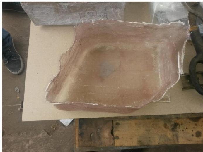
**Figura 33 Air- Box retirado del molde primario**
