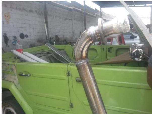
**Figura 38 Sueldas sanitarias en el primer codo**
