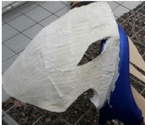
**Figura 21 Modelado de cartón de la parte frontal de carenado**
