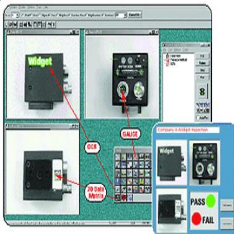
Figura 13 Software que permite la identificación de objetos
