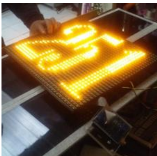
Figura 66. b) Encendido Matriz de leds.
