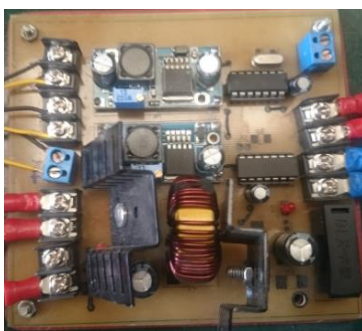
Figura 35. Regulador de voltaje
