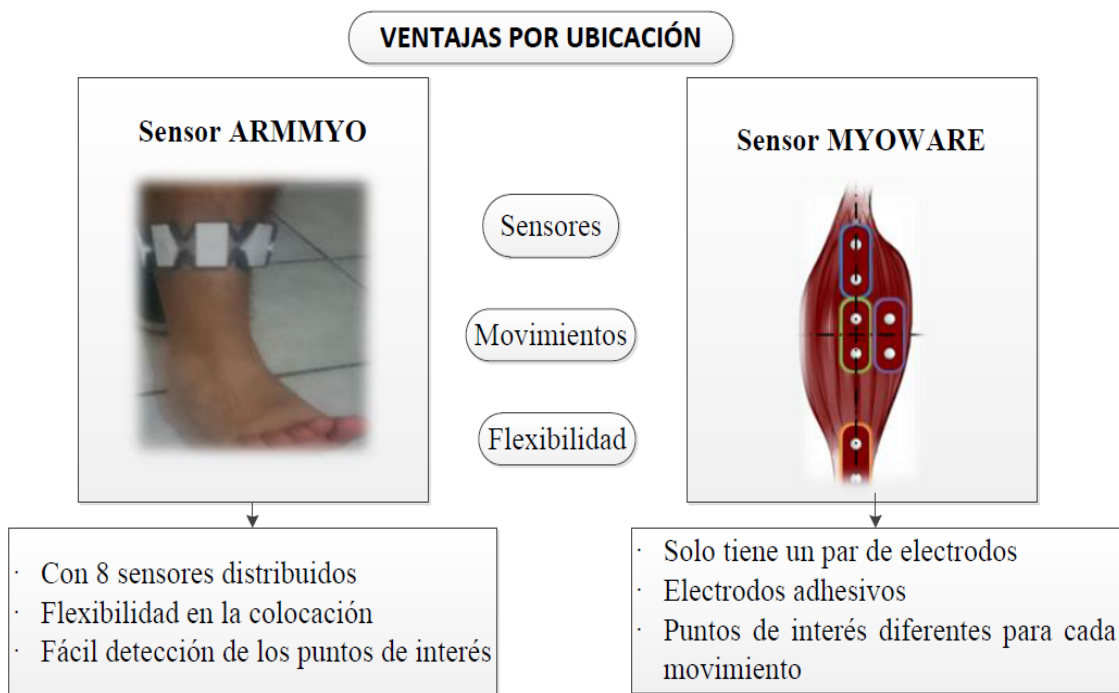
Figura 23: Colocación de múltiples sensores para flexibilidad de movimientos
