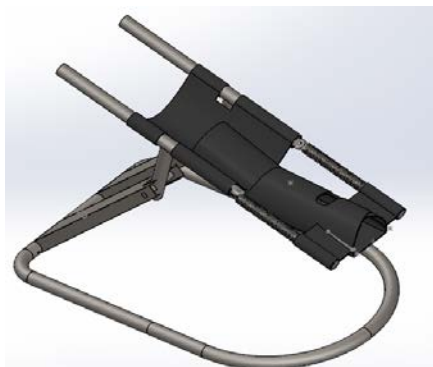
Figura 37: Solución B (ganadora) de estructura estática del rehabilitador
