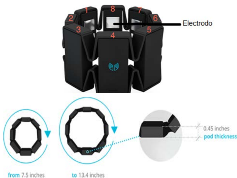
Figura 18: Disposición y dimensión de sensor Myo Armband
