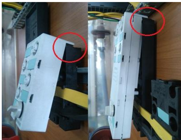
Figura 88. Montaje de las dos partes de los esclavos AS-i
