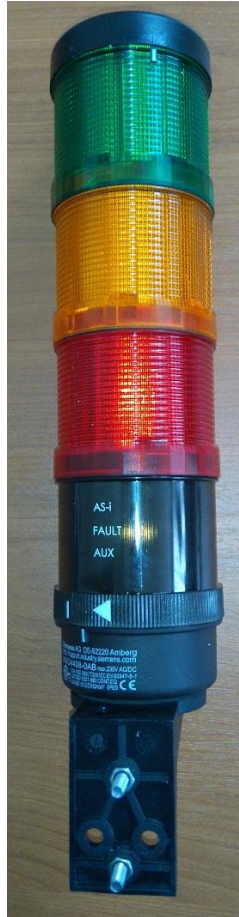
Figura 63. Esclavo A/B columna de señalización AS-interface
