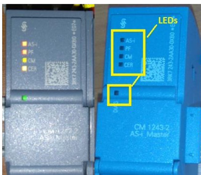
Figura 127. Fallas en el maestro AS-i
