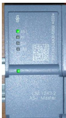
Figura 128. Maestro correctamente configurado
