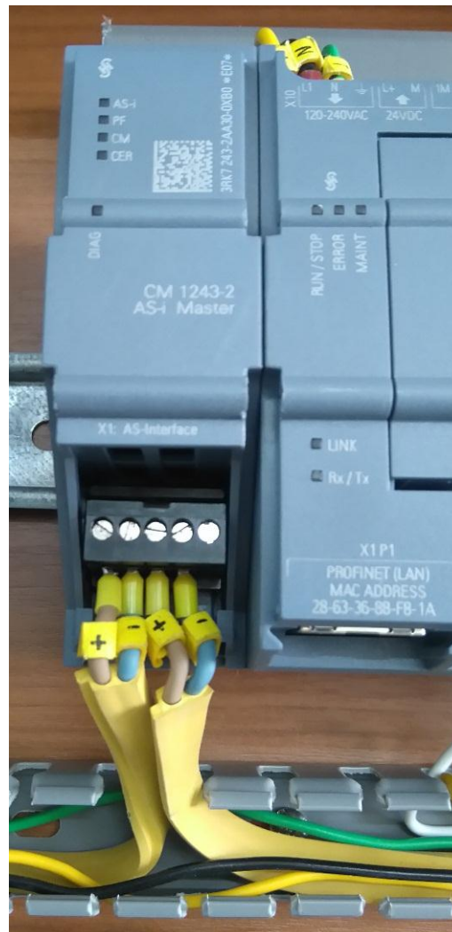
Figura 82. Conexión del Maestro AS-i CM 1243-2
