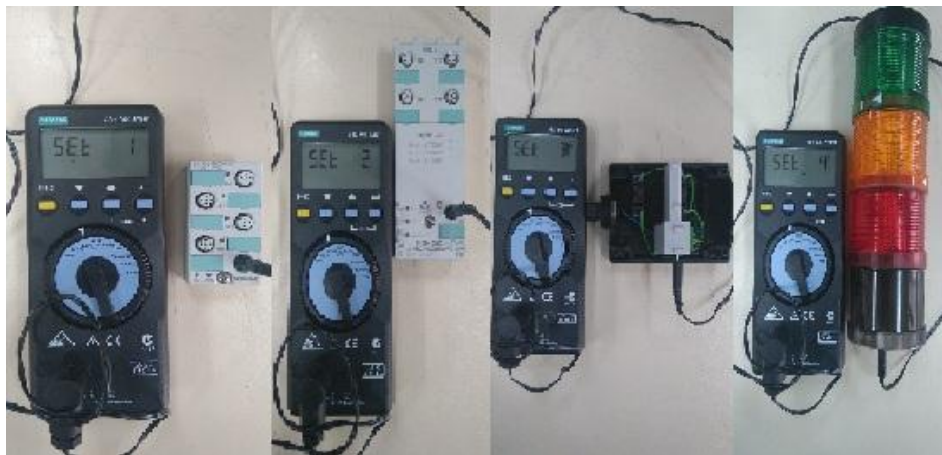
Figura 96. Direccionamiento de los esclavos AS-i
